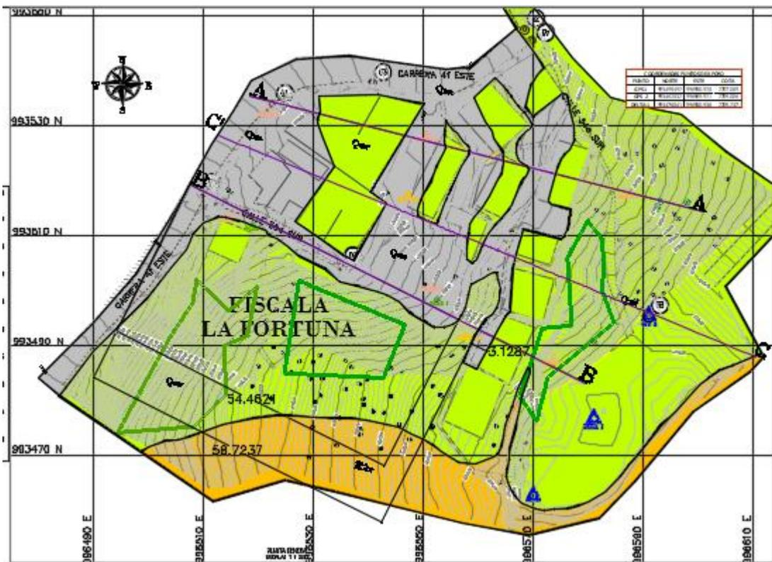
**Figura 22** Plano geológico y localización de secciones de análisis
