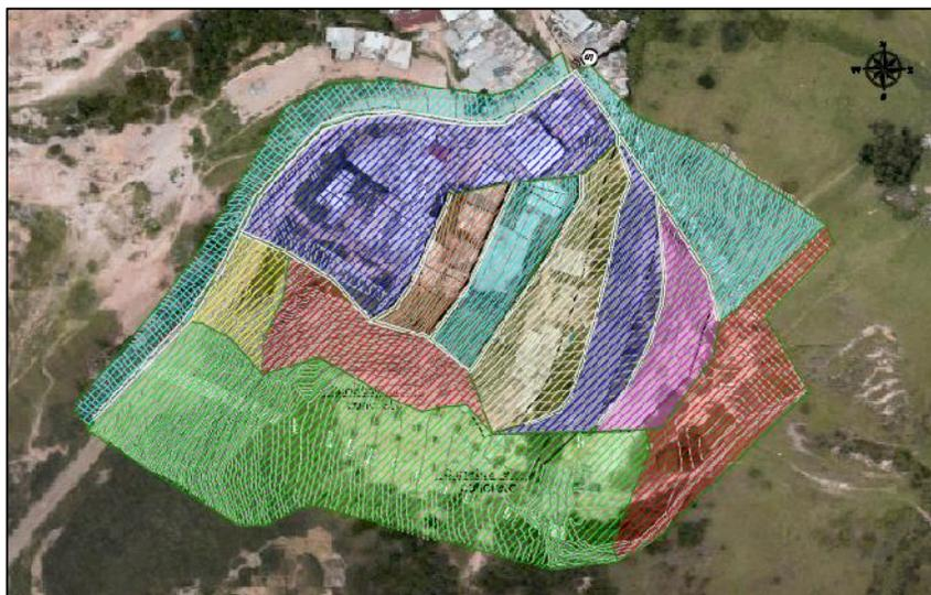
**Figura 73** Áreas de drenaje para los canales
