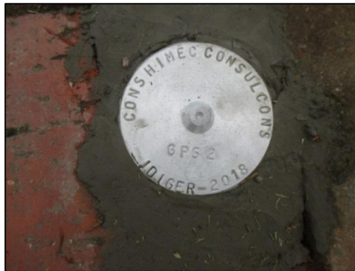
Fotografía 4. Referencias materializadas y posicionadas mediante proceso GPS (GPS1 Y GPS2) Fuente: Consorcio Himec – Consulcons 2017
