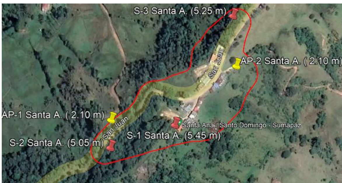
Figura 49- Localización de perforación ejecutada.
