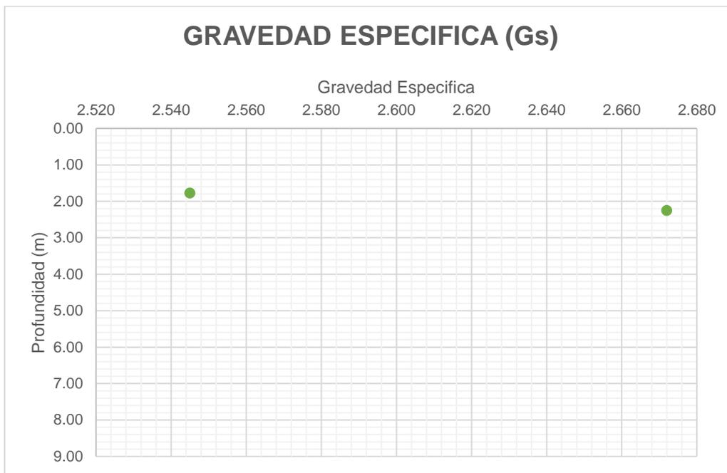
**Figura 55. % Gravedad específica Vs Profundidad**
