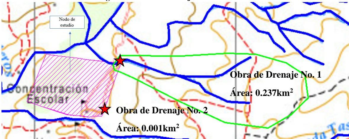
Figura 36. Áreas de Drenaje Obras Existentes
