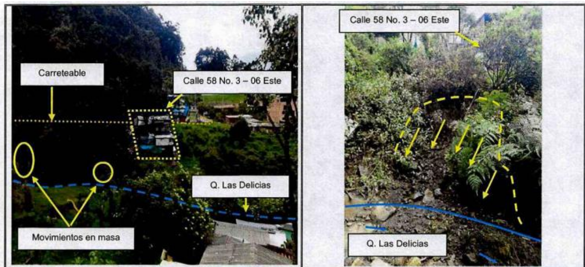
Figura 11. Fotografías asociadas con los movimientos en masa identificados en la margen izquierda de la Quebrada las Delicias por socavación lateral del cauce. DI-10819. Julio de 2017. IDIGER (2017)
