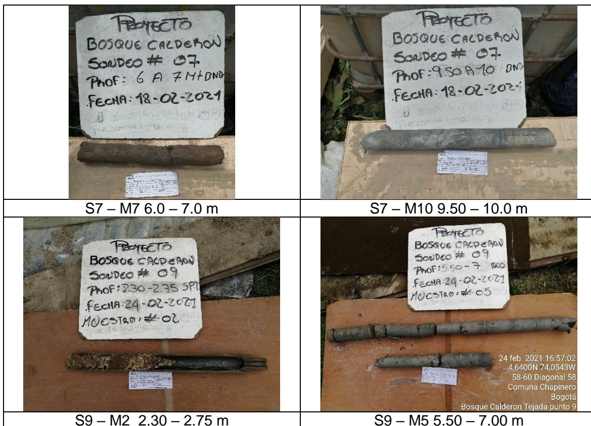
Figura 78. Registro fotográfico de algunas de las muestras obtenidas de los sondeos.
