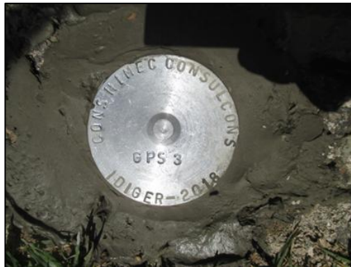
Fotografía 3. Referencia materializada y posicionamiento mediante proceso GPS punto GPS3.
