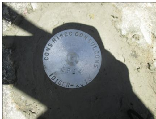
Fotografía 4. Referencia materializada y posicionamiento mediante proceso GPS punto GPS4.
