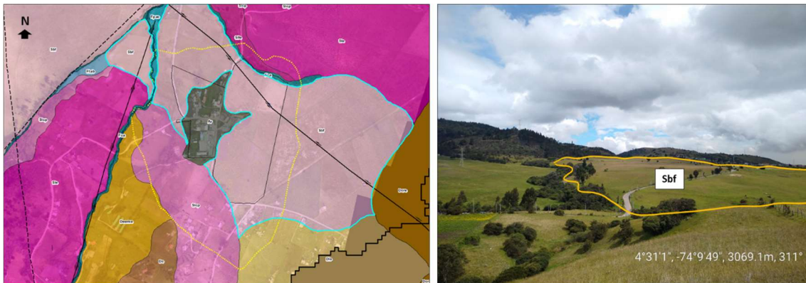
Figura 19. Terraza o berma de fallamiento (Sbf). Vista en planta y panorámica en campo. Sector Quiba Alta. Fuente: autores
