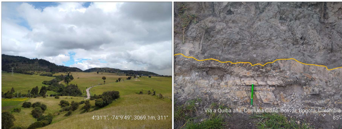
Figura 13. Apariencia superficial y en perfil de los suelos residuales de la formación Labor-Tierna. Sector Quiba Alta. Fuente: autores
