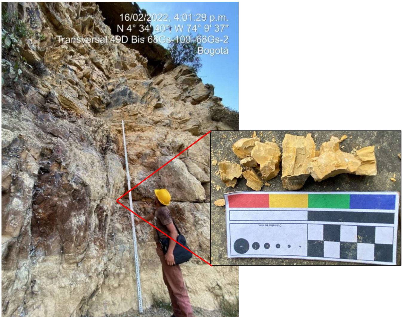
Figura 22 Niveles centimétricos de roca arcillolita en forma de lentes intercalando la secuencia de arenisca
