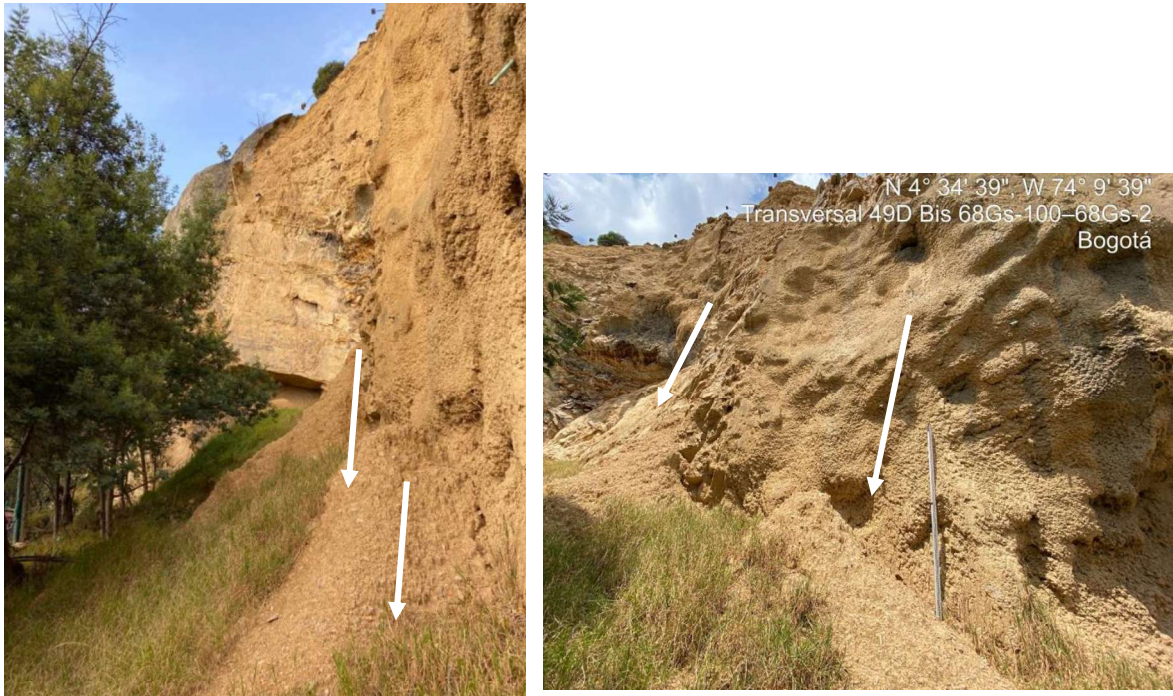
Figura 43 Movimiento en masa N°3 tipo caída de tierra y detritos
