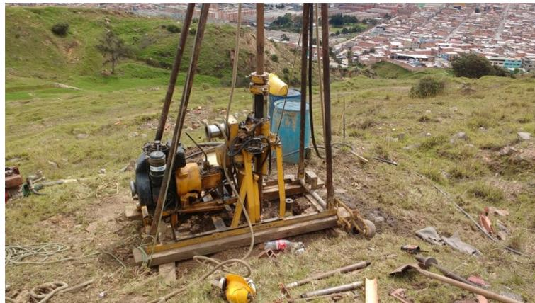
*Imagen 129 Equipo de perforación localizado en el sondeo IUD10*
