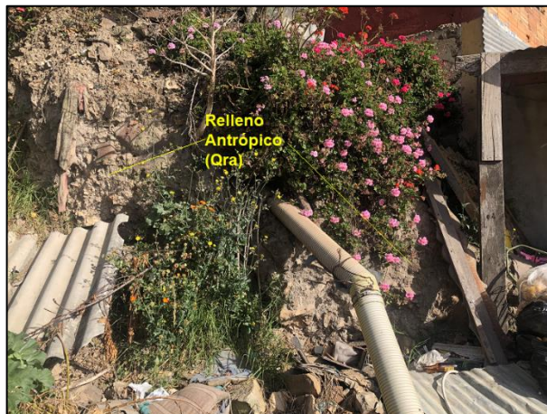
Fotografía 5 Relleno heterogéneo identificado al costado nororiental del área de estudio, Sector Santa Rosita – Las Vegas.
