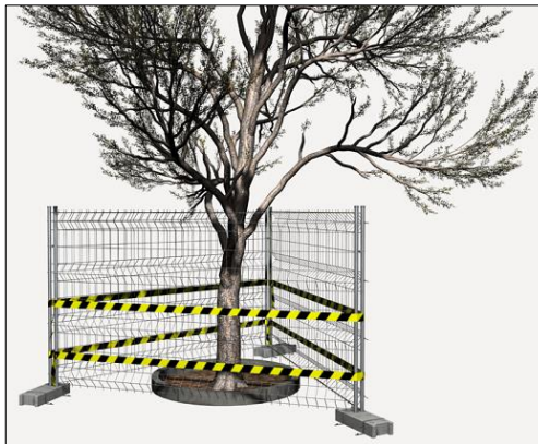
Figura 6. Barrera de protección.
