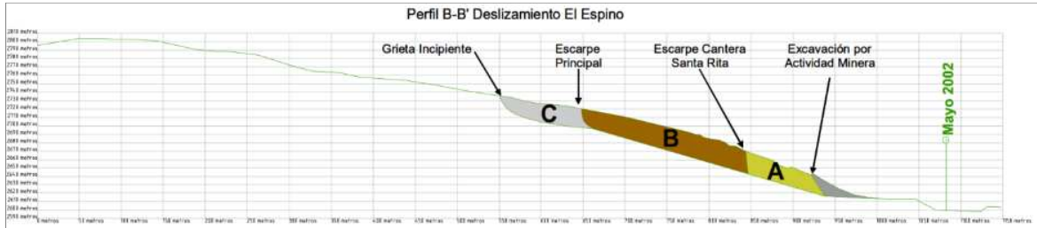
Ilustración 2-4 Modelamiento del deslizamiento de los diferentes bloques.
