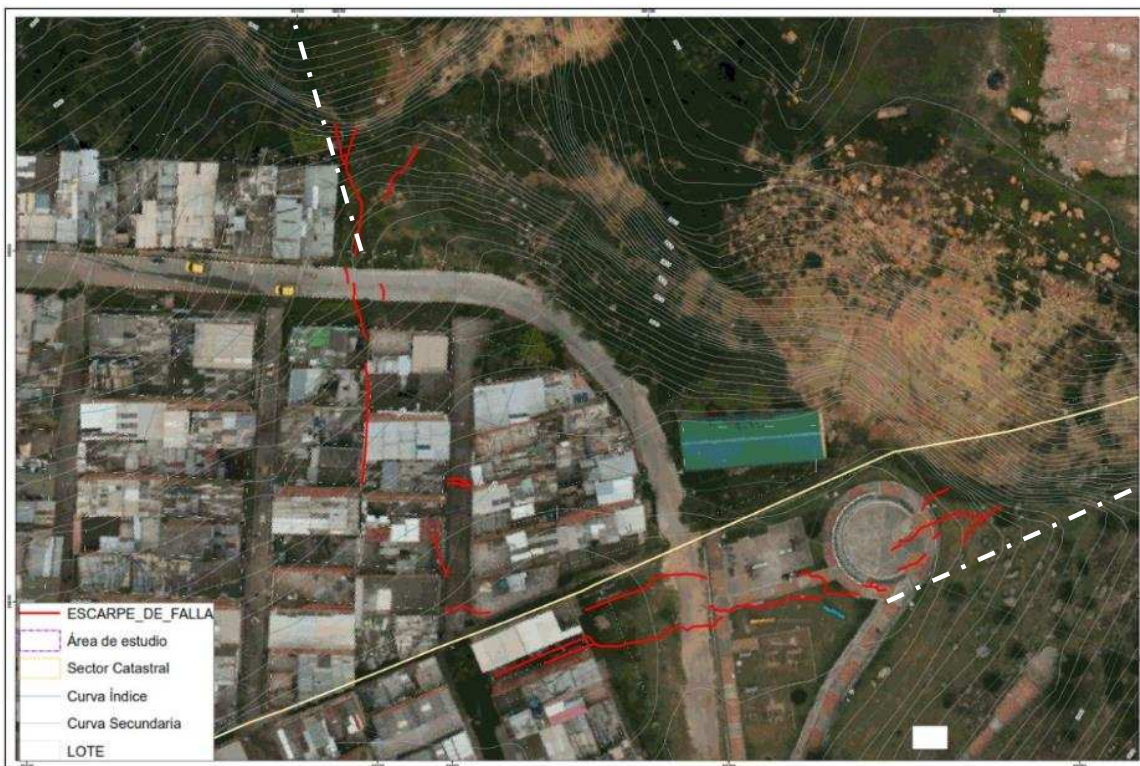
Ilustración 4-54 Cartografía de grietas – Levantamiento en campo. El trazado en blanco Las líneas blancas marcan la dirección de los taludes mineros y las líneas rojas delimitan las grietas
