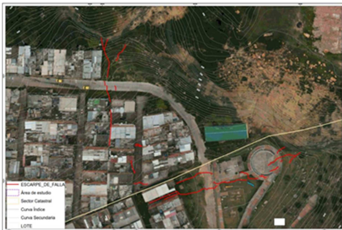
Ilustración 4-55 Cartografía de grietas – levantamiento en campo. El trazado en blanco las líneas blancas marcan la dirección de los taludes mineros y las líneas rojas delimitan las grietas.
