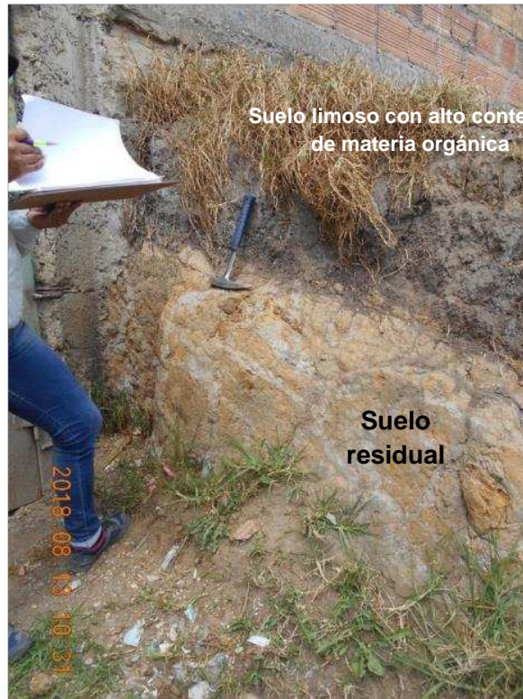
Ilustración 4-16 Trincheras – 3 Coordenadas E: 90040 m N: 98484 m
