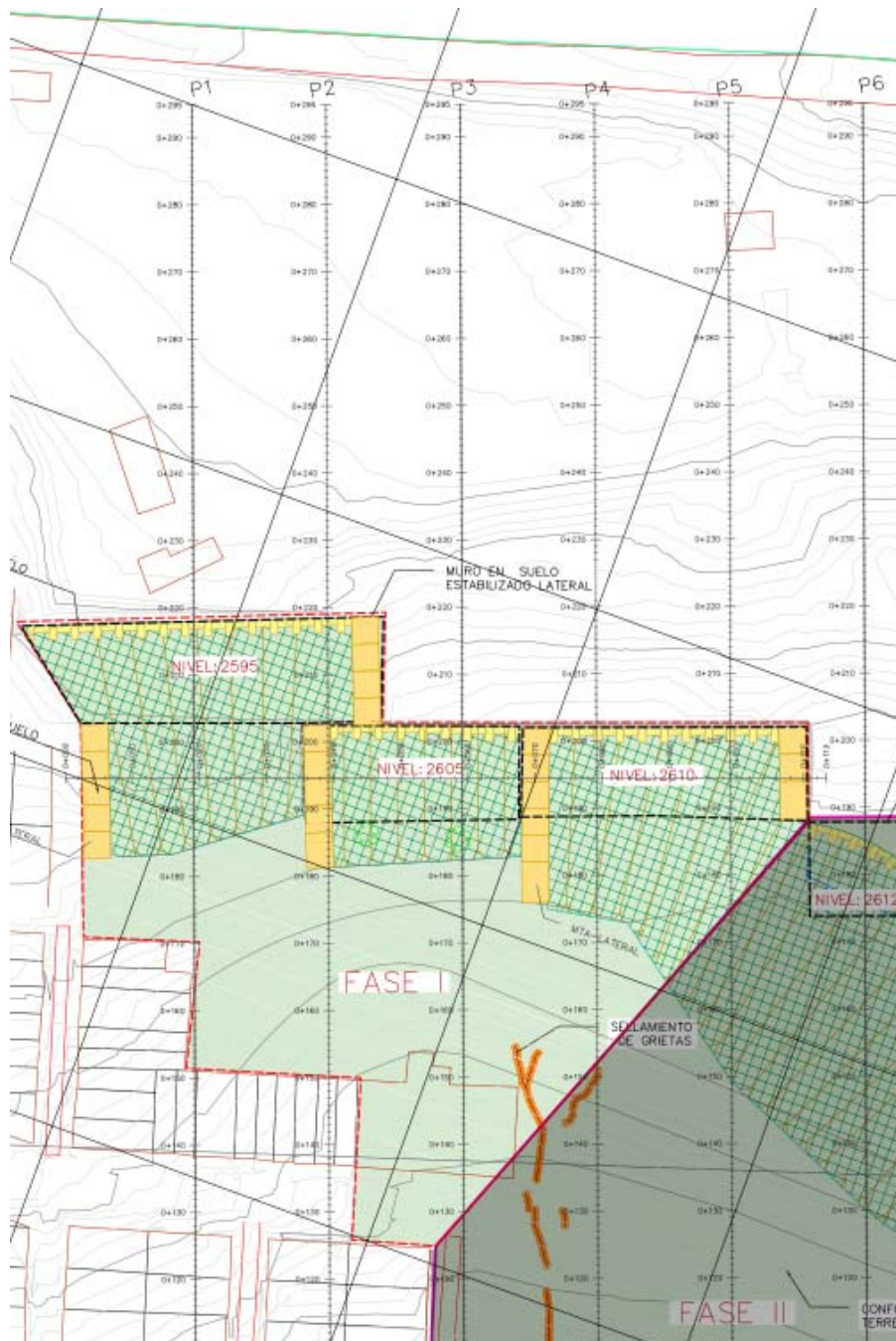
Ilustración 9-6 Fase I. Ejecución muro en tierra armada en la Fase I
