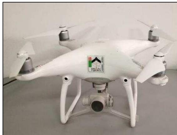
Ilustración 4-15 Equipo UAV marca DJI del tipo cuadricoptero. Fuente propia.
