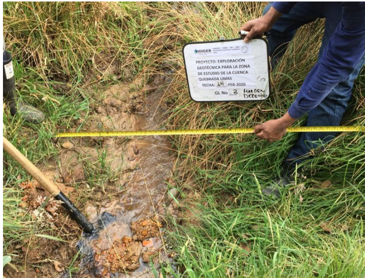
Figura 24 Ilustración del proceso de recolección de muestras de lecho para ensayos de granulometría
