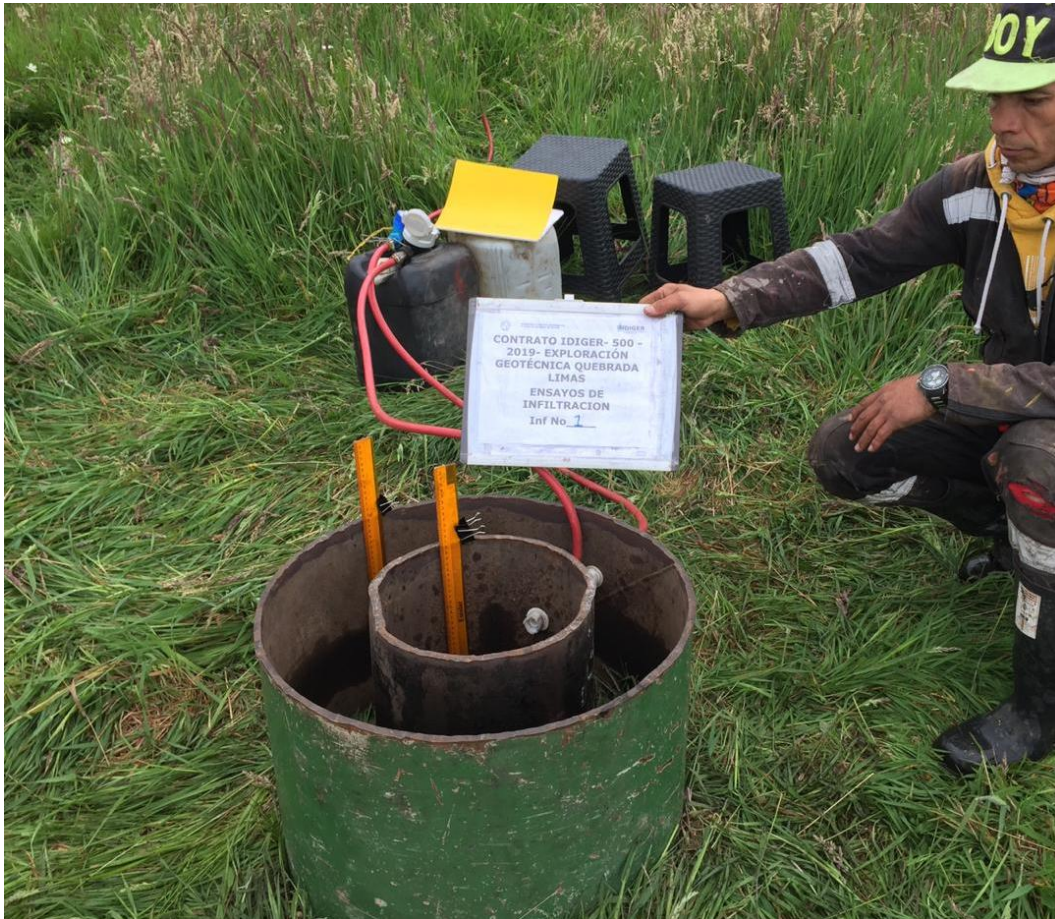
Figura 19 Detalle del doble anillo con sus reglas de control de nivel, rótulo de identificación del punto, mangueras y medidores de volumen
