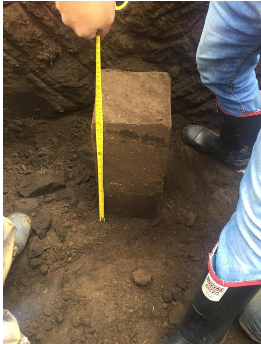
Figura 9 Toma de muestra de fondo en apique
