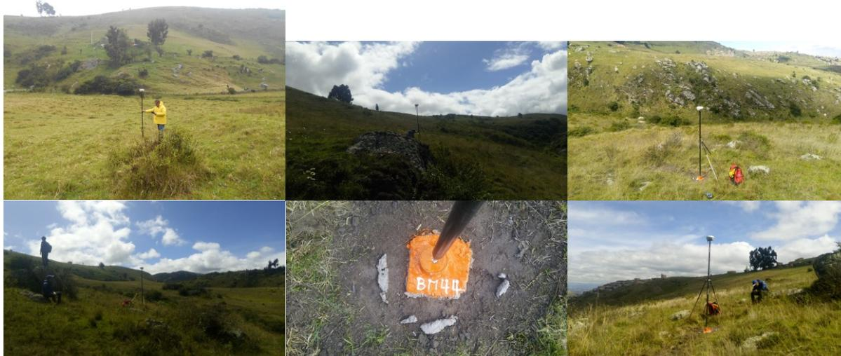
Ilustración 38. Levantamiento de detalles mediante RTK
