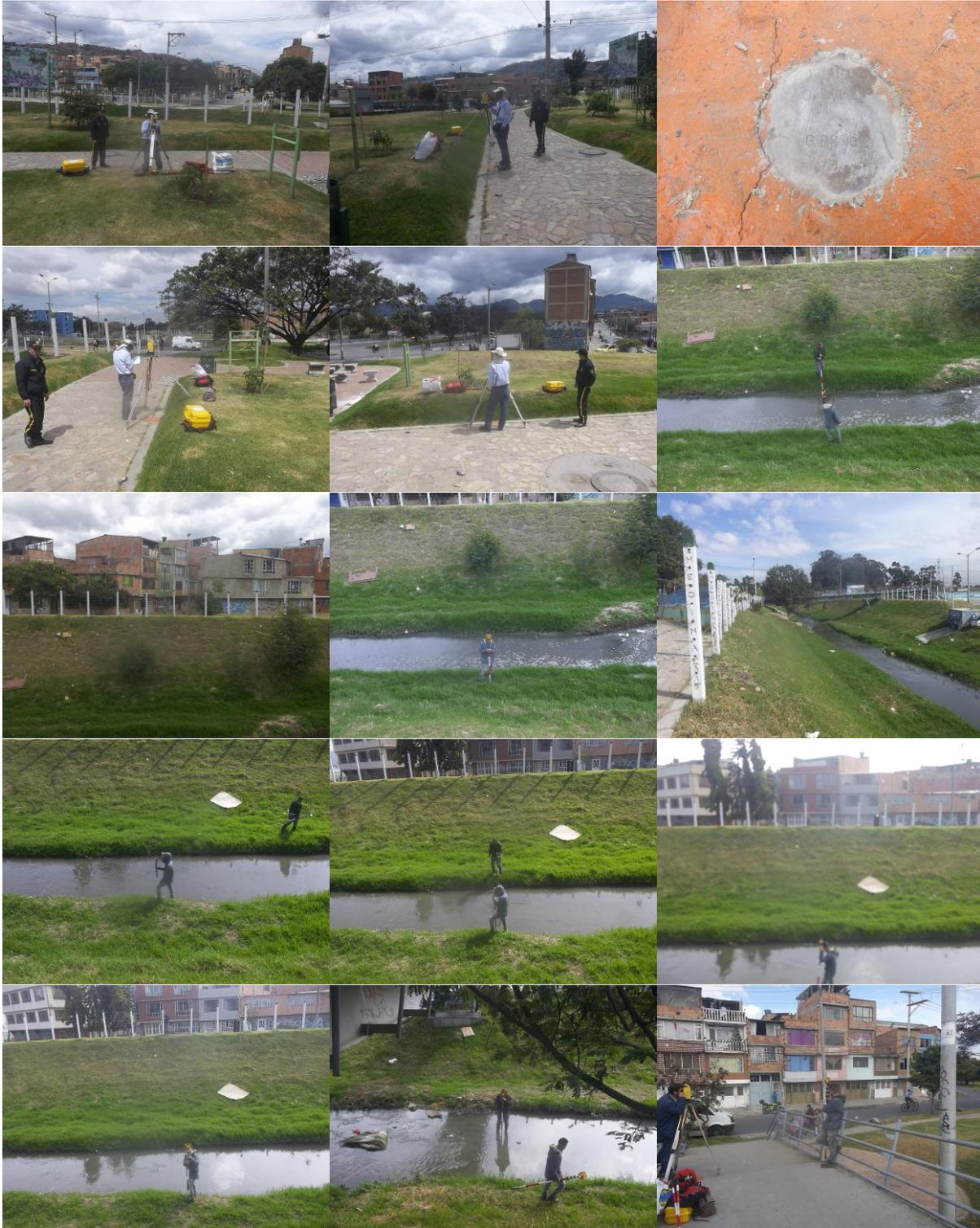
Ilustración 33. Levantamiento de secciones mediante radiación de detalles
