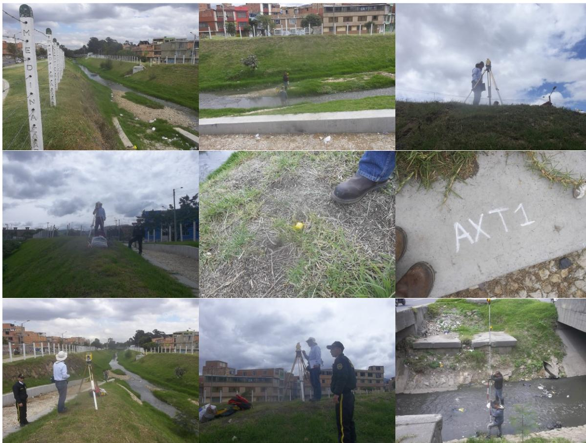
Ilustración 37. Levantamiento de secciones mediante radiación de detalles
