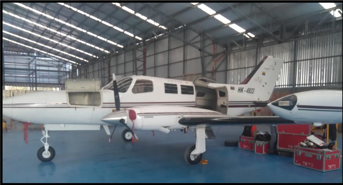
Ilustración 83. Montaje del sensor ALS70HP + RDC30 en la aeronave Cessna 402B
