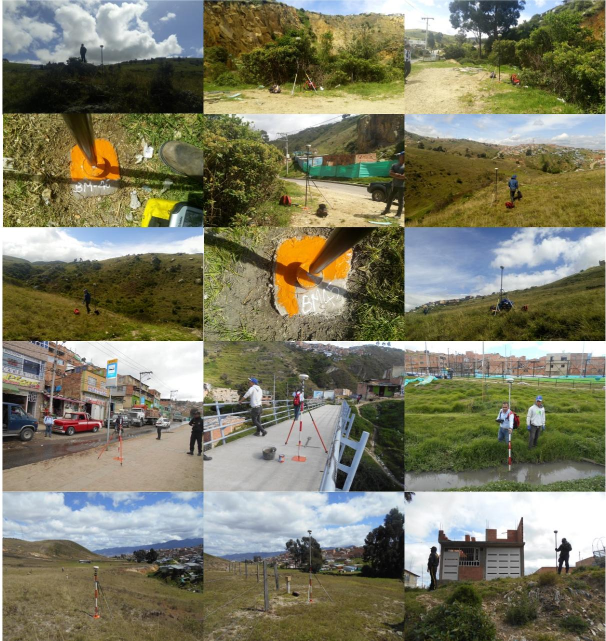
Ilustración 39. Levantamiento de detalles mediante RTK
