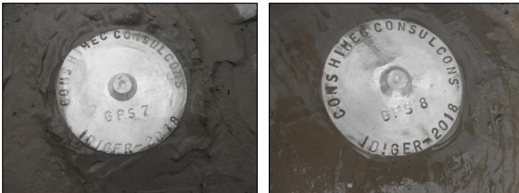
Fotografía 6. Referencia materializada y posicionamiento mediante proceso GPS punto GPS7 y GPS8.
