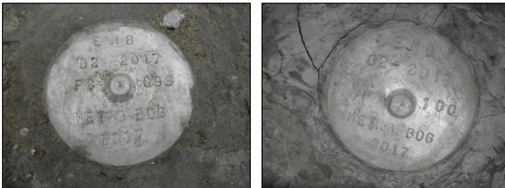
Fotografía 7. Referencia materializada y posicionamiento mediante proceso GPS punto PC99 y PC100.
