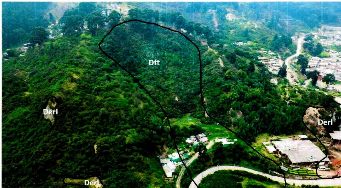
**Fotografía 17.** Vista panorámica de los diferentes movimientos en masa identificados en el polígono del plan parcial (sección norte)
