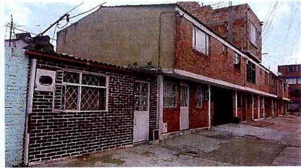
**Fotografía N°4.** Panorámica predios ubicados en el costado Sur sobre Calle 42G Sur. Edificaciones de uso residencial de uno, dos y tres niveles con sistema estructural tipo mampostería.
