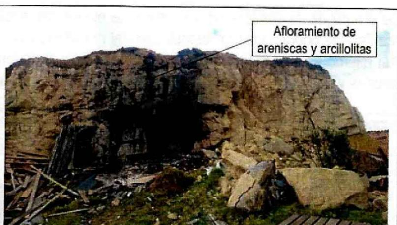
**Fotografía 4.** Afloramiento de areniscas correspondiente a la Formación La Regadera Superior (Ters) ubicado en la parte posterior de la manzana 4 del desarrollo La Esperanza Alta (sureste).
