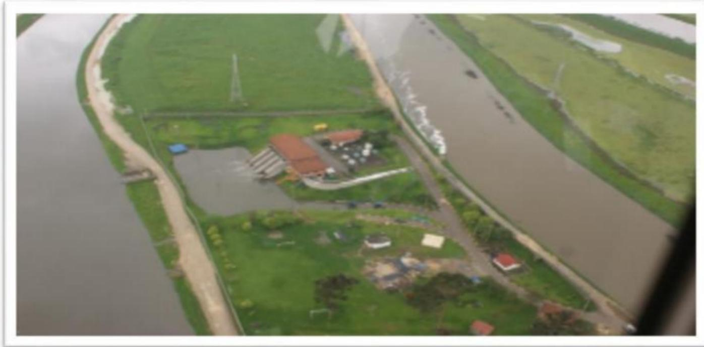
**Foto 1. Estación de bombeo de Gibraltar ahogada por niveles altos en el Canal Cundinamarca y en el Río Bogotá. Inundación en Kennedy\_Bosa 2011.
