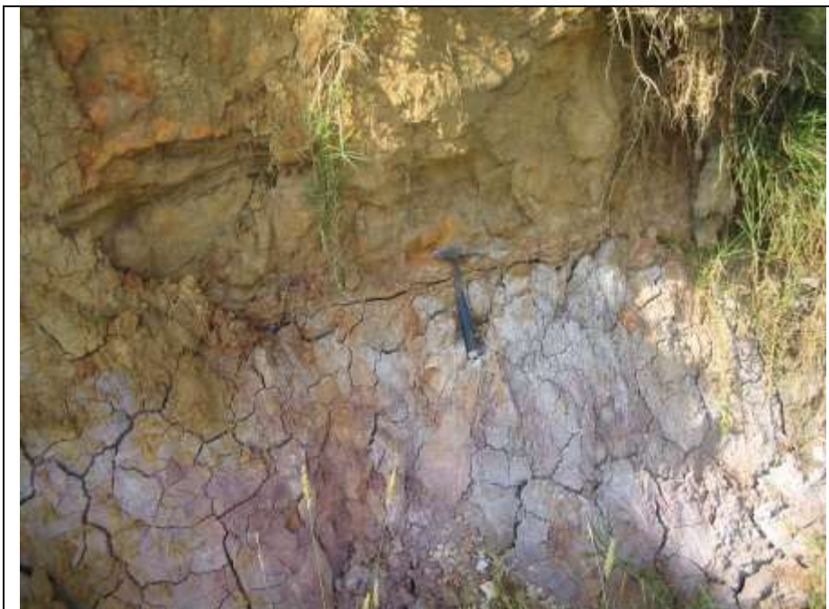
Fotografía 1. Contacto entre la capa de arenisca (parte superior de la foto) y la arcillolita. Nótase la disposición sub-horizontal de los estratos.
