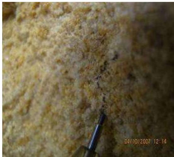
Fotografía 5.1 Cuarzo arenita de la Formación Guaduas. Nótese la escala corresponde a mina de diámetro de 0.05 mm.
