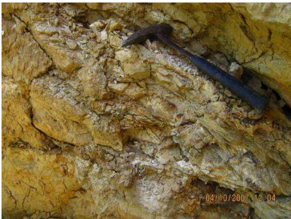
**Fotografía 5.9 Fracturación intra-estratificada**
