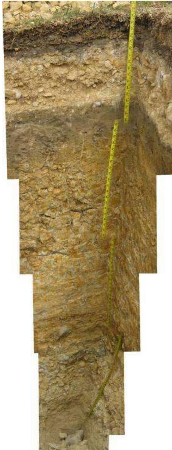
**Fotografía 5.2 Apique AP - 2. Obsérvese la secuencia transicional de los horizontes VI a III de meteorización. Arriba la presencia de un angosto nivel de suelo orgánico, sobre suelo de arcilla compacta.**
