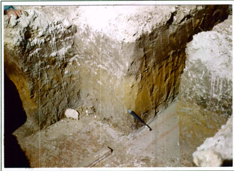
Foto 1. Sector de Guaymaral. Excavación para construcción. Obsérvese dos horizontes oscuros (correspondientes a suelos, separados por un nivel de color amarillo limo-arcilloso de la Terraza Alta).
