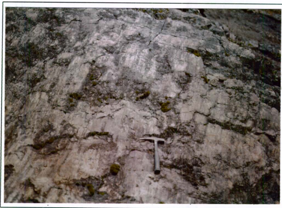
Foto 36. Espejos de falla del Alto El Cabo por la vía Bogotá-Choachi (Km 6+190 m, contados a partir de La Circunvalar), con una orientación N20E/34NW, en areniscas.
