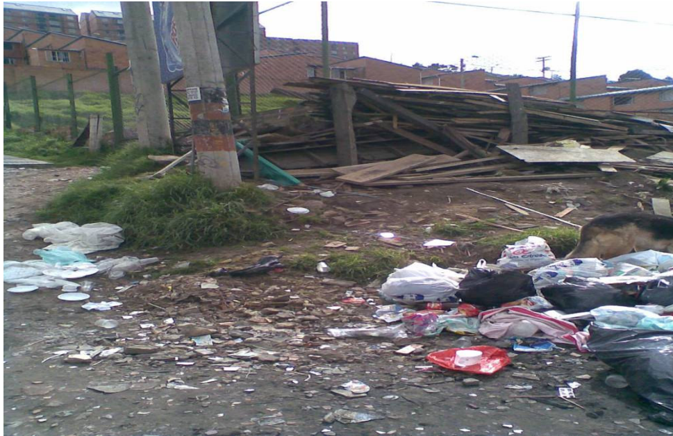
Fotografía No. 29 Calle 189 Carrera 9. Escombros de materiales y basuras, las cuales, como producto de la escorrentía viajan hacia aguas abajo colmatando los sistemas de alcantarillado.
