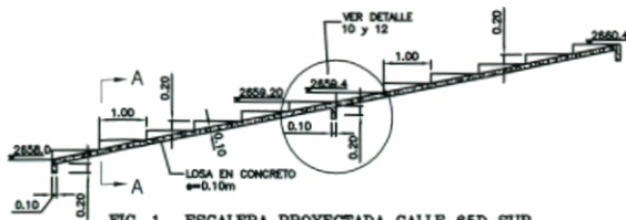
FIG. 1- ESCALERA PROYECTADA CALLE 65D SUR ESCALA 1:75
