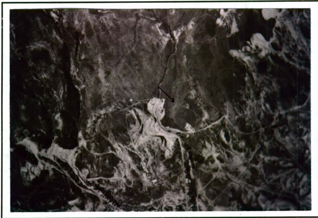
FOTO 19. IMAGEN DE 1970. LA FLECHA MUESTRA EL AREA CORRESPONDIENTE AL ACTUAL BARRIO SAN RAFAEL. NOTESE LA EXPLOTACIÓN MINERA ANTITÉCNICA Y LA AUSENCIA DE EVIDENCIAS DE INESTABILIDAD EN LAS ZONAS DE ESCARPE NO AFECTADAS POR LA EXTRACCIÓN
