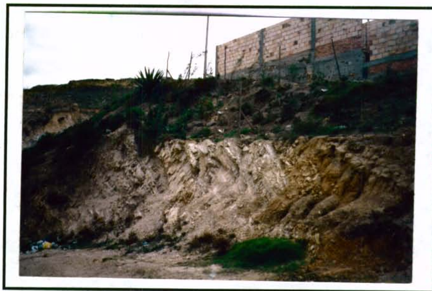
FOTO 1. SECUENCIA ROCOSA CORRESPONDIENTE A LA UNIDAD INFORMAL TKGM 1 , COMPUESTA POR ARENISCAS LODOSAS Y LODOLITAS. EN EL EXTREMO SUPERIOR DERECHO, LA CASA MAS BAJA DE LA MANZANA N DEL BARRIO SAN RAFAEL.
