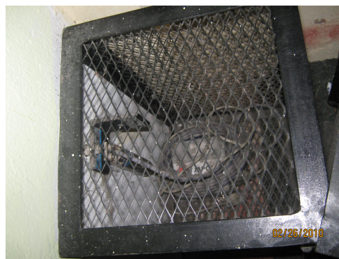
Fotografía 1-2. Inclinómetro encontrado durante la visita de inspección en el sector del Espino. Fotografía 1.3. Tiltmeter electrónico instalado por JICA.
