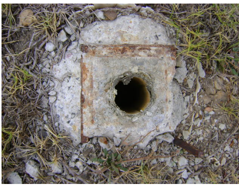
Fotografía 1-2. Inclinómetro encontrado durante la visita de inspección en el sector del Espino. Fotografía 1.3. Tiltmeter electrónico instalado por JICA.
