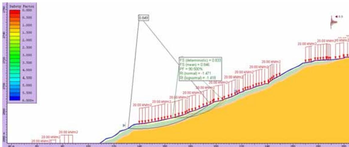
Figura 11-16 Modelo de falla sección B-B' – sector 3 con agua extrema y sismo
