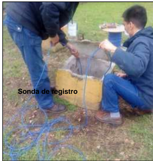
Fotografía 18. Verificación del estado del piezómetro tipo Casagrande – CNA.
