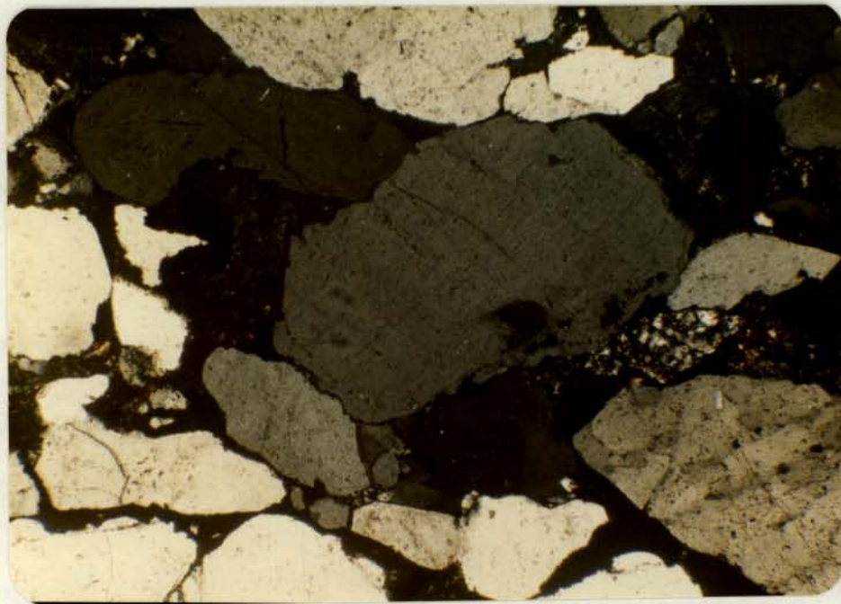
Foto No. 10.- Placa E-7. A=6.3 x Nícoles cruzados. Misma foto anterior, con luz polarizada en dos direcciones.
