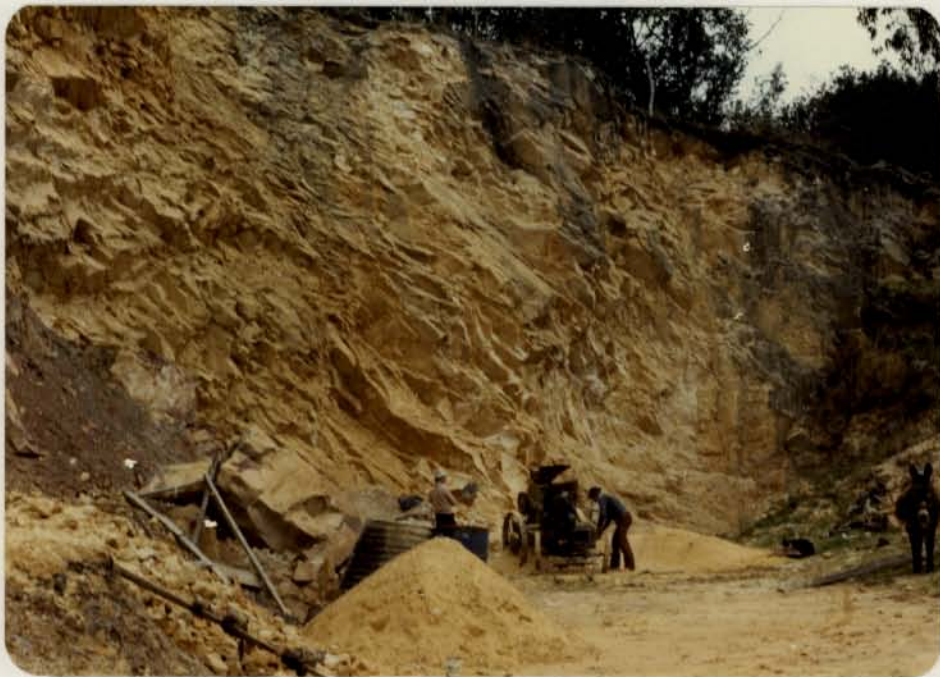
Foto 12.- Cantera "El Salitre" sobre la carretera Bogotá-La Calera antes de llegar al Río Teusacá. Pequeña explotación para arena de los niveles de A. Labor color amarillo grano fino a medio, bastante fracturada.
