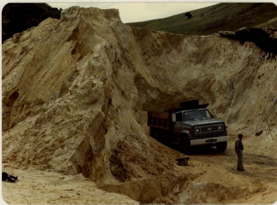
Foto 22.- Cantera a 2.9 km. de la Central hacia el E. Arenisca La Regadera bastante gruesa friable con grava fina. Hay ensayo de granulometría en este punto.
