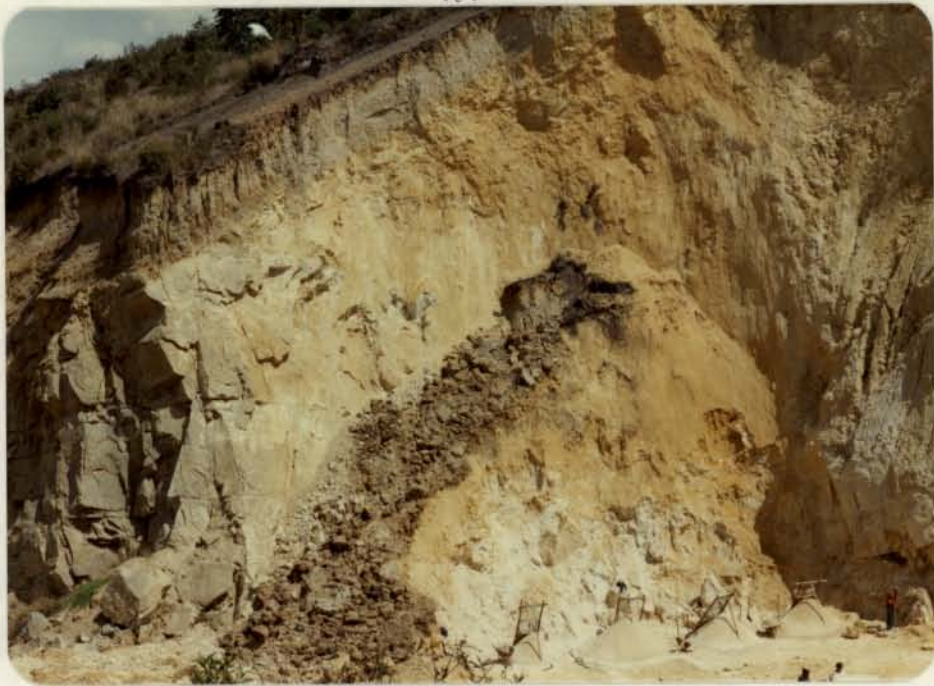
Foto 55.- Frente de explotación de arenas en la Formación Labor. Obsérvese los desprendimientos provocados con los suelos orgánicos y su explotación manual. Sector Sopó-Tocancipá.
