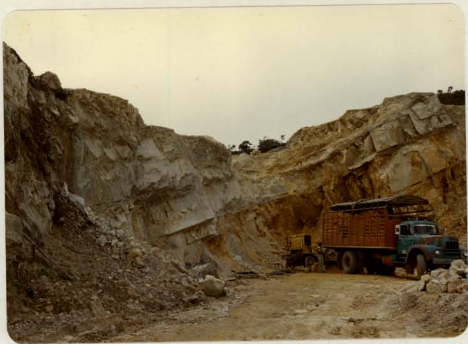
Foto 20.- Explotación de arenas de la Formación Cacho. Obsérvese la inclinación de las capas que delimitan su explotación y la variación de color por cementación.
