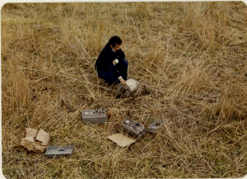
Foto 56.- Operador y equipo en la toma de sondeos geoelectricos para determinar materiales en el subsuelo especialmente los niveles de gravas.
