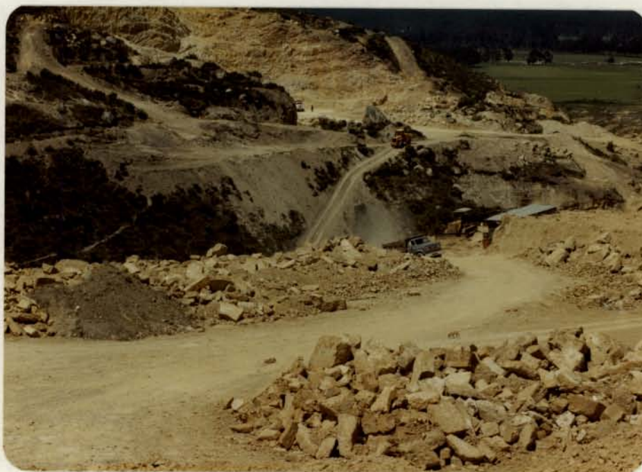
Foto 30.- Canteras de Sico junto a la Laguna de Terreros, donde explotan recebo del nivel de Plaeners y bloques de piedra.
