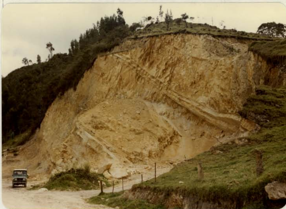
Foto 5.- Explotación de areniscas muy fracturadas de la Formación Arenisca Dura en La Calera.
