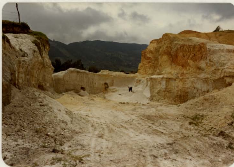
Foto 14.- Explotación de arenas para vidrios de la Formación Arenisca Tierna. Observe la delimitación del nivel en explotación. Sector Sibaté.
