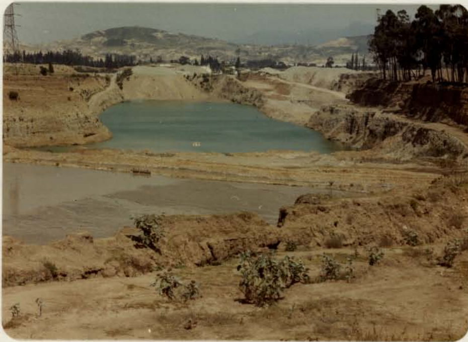
Foto 40.- Zona de Tunjuelo. Hueco de Ingeniera de 500 x 150 x 20 m.
