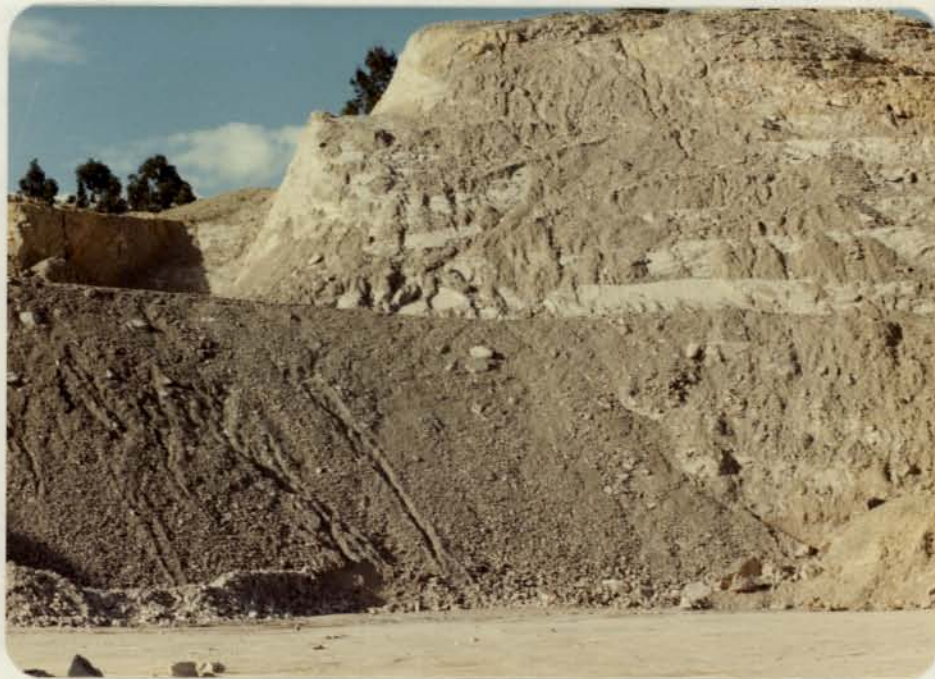
Foto 28.- Vereda Astorga, Municipio Nemocón, Mina Sumicol. Explotación de plaeners caoliníticos en forma aterrazada.
