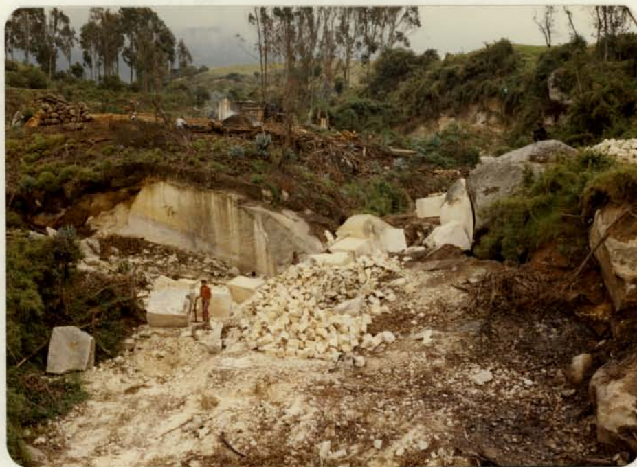
Foto 54.- Explotación de bloques sueltos de los depósitos de coluvios en la vía Sibaté-San Miguel.
