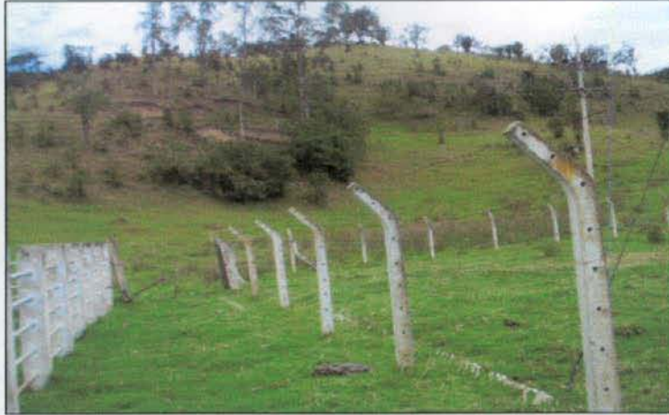
Foto 4-30 Depresión con patrones de movimiento recientes en materiales arcillosos, blandos y con abundante humedad.
