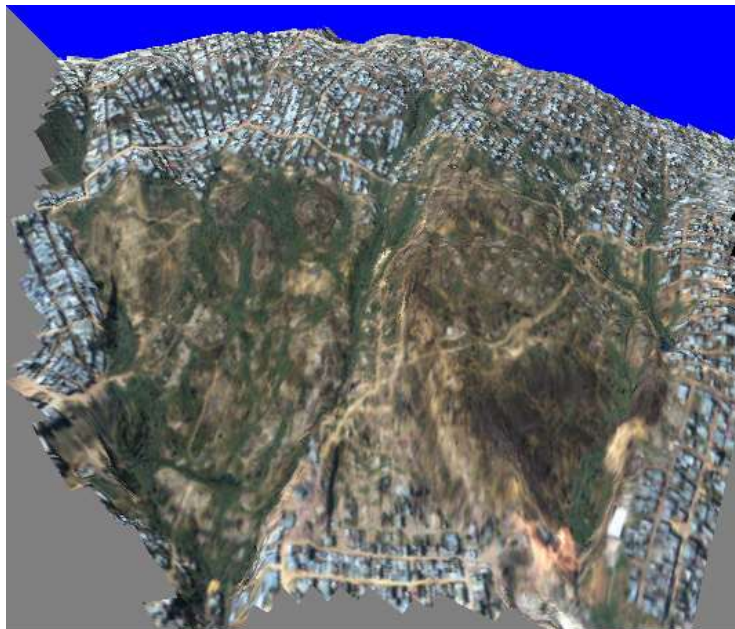
Foto 4-3 Detalle de la zona de los deslizamientos de La Carbonera y El Espino, con el marcado contraste de lineamientos estructurales
