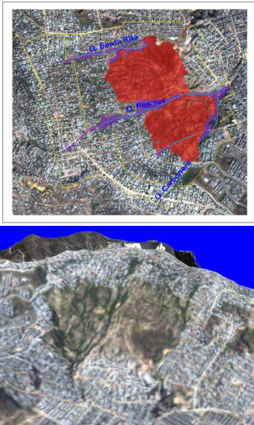
Foto 4-34 Vista en planta y en 3D de las zonas de deslizamiento en el año 2004. En rojo se observan las áreas afectadas por movimientos en masa y en morado depresiones aluviales con procesos de reptación, se han evacuado las viviendas en las zonas de los deslizamientos.
