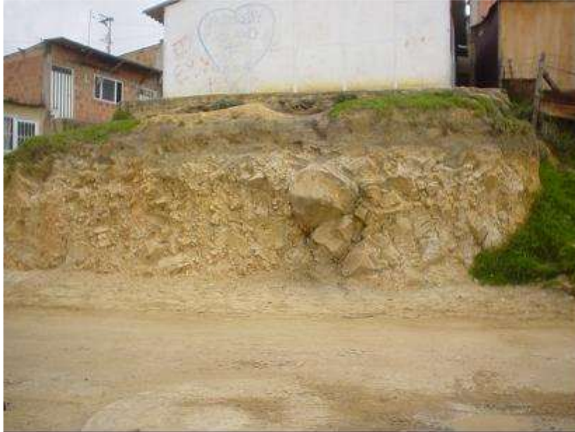
Foto 3-30 Detalle de depósitos fluvio-glaciales en la parte alta de La Carbonera. Obsérvese en la parte superior del mismo los suelos orgánicos y la presencia de bloques erráticos de areniscas en una matriz amarillenta en el depósito mismo.
