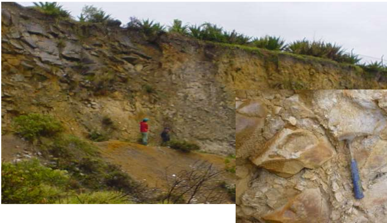
Foto 3-6 Vista panorámica y detalle de la zona de falla de Mochuelo. Nótese la brecha de Falla con fragmentos fracturados
