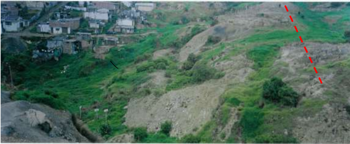
Foto 3-12 Vista de campo de la Falla El Morro en la pata del deslizamiento. La flecha indica un montículo recientemente levantado por el empuje del deslizamiento.
