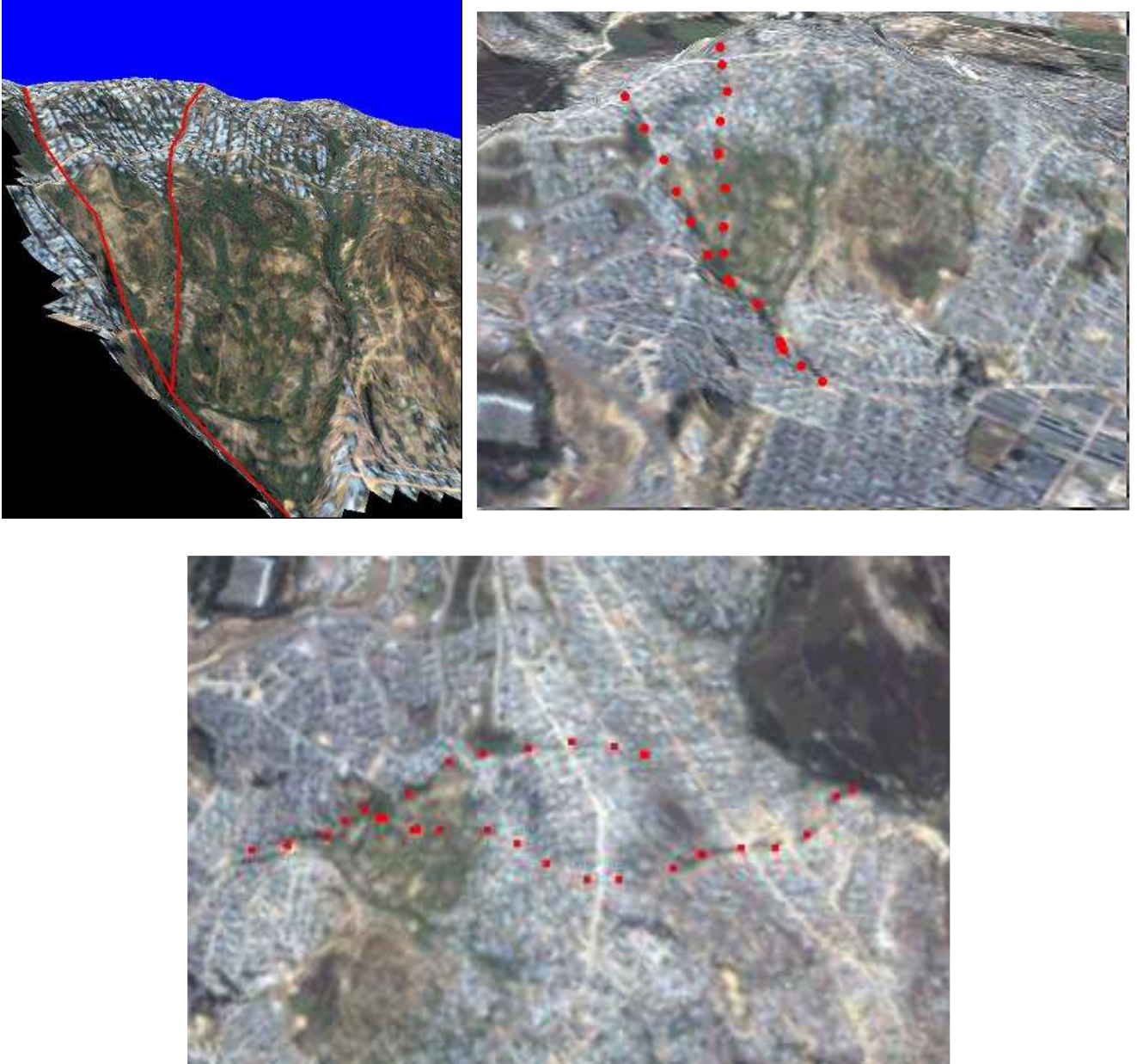
Foto 3-9 Vista frontal y panorámicas de la Falla La Carbonera siguiendo el curso de la quebrada Carbonera. Presenta dos ramales.
