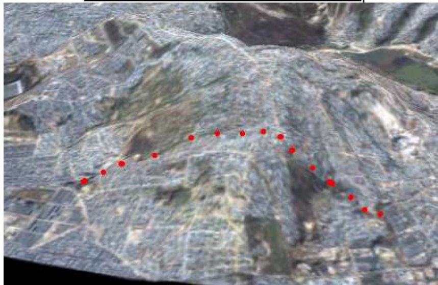
Foto 3-3 Vista frontal y panorámica en 3D del lineamiento morfológico que deja el trazo de la Falla de Santa Rita (en rojo).
