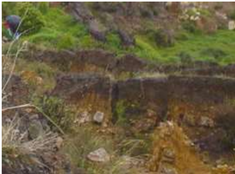
Foto 3-25 Detalle del depósito de deslizamiento Dze_Sr+Ac en donde existe un suelo residual superficial cubriendo un depósito con una matriz predominantemente de material arcilloso.
