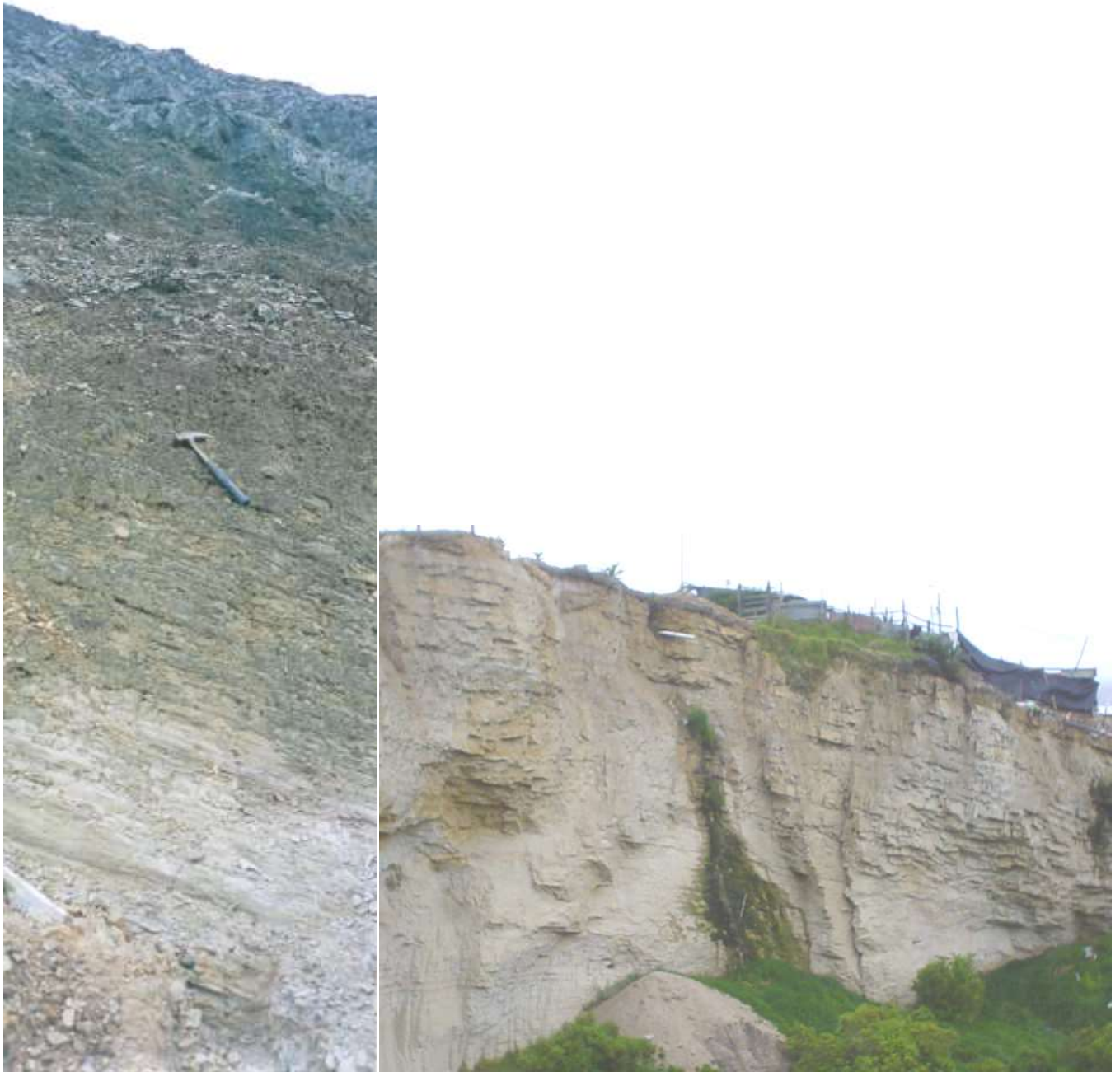
Foto 3-32 Detalle de afloramiento de lodolitas con capas de arenisca en la margen Izquierda de la quebrada Rosales
