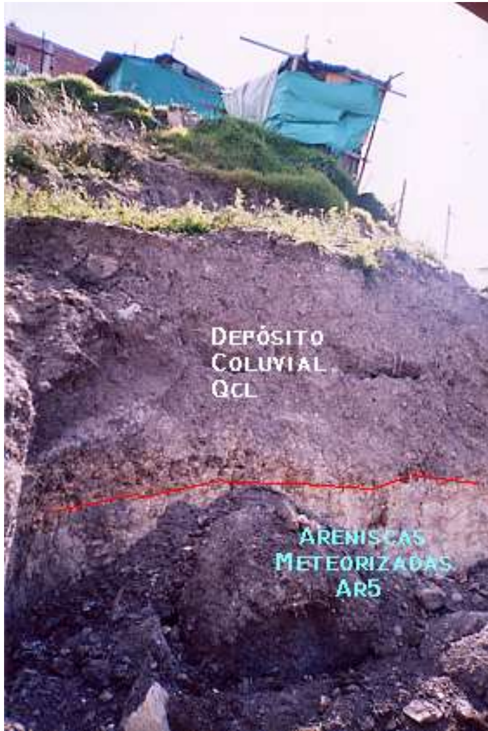
Fotografía 3. 17 Parte central de la zona de estudio Manzana 7. Desprendimientos en los cortes del Depósito Coluvial (Qc), se observan las areniscas de la Unidad Ar5 en la base del Talud
