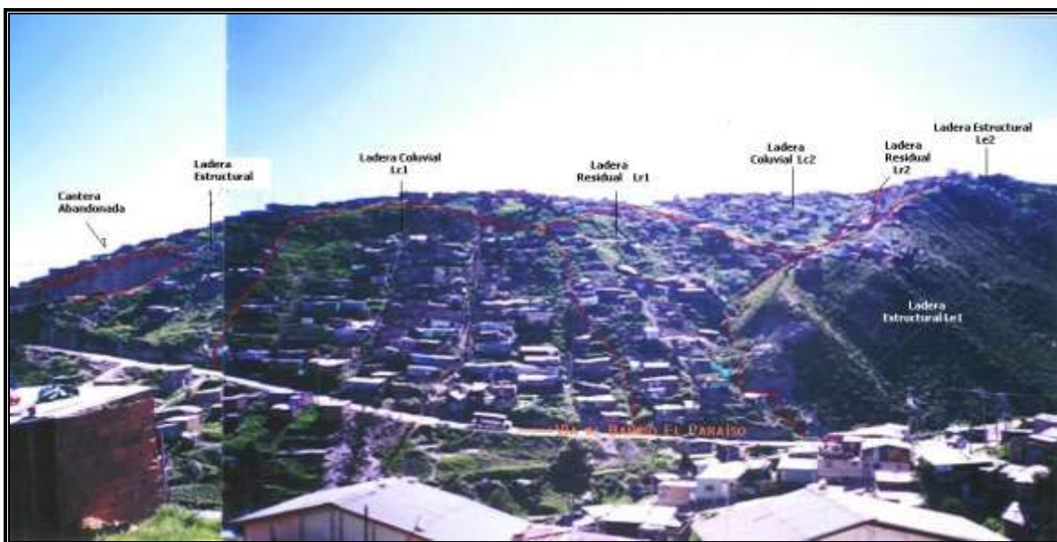
Fotografía 3. 20 Panorámica de la parte Sur y centro de la zona de estudio donde se aprecian las laderas coluviales, residuales y estructurales
