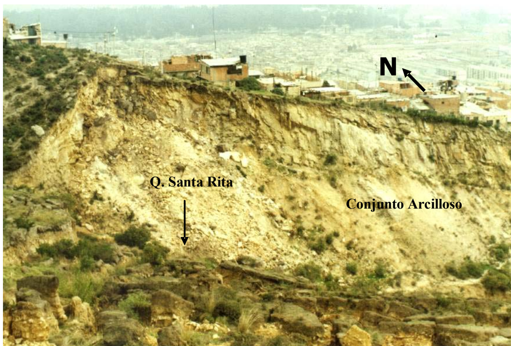
Foto 4.2. Sector de la Quebrada Santa Rita, donde se levantó la segunda columna estratigráfica. Conjunto Arcilloso intercalado con paquetes de areniscas hacia el tope (Formación Guaduas). (May/02).
