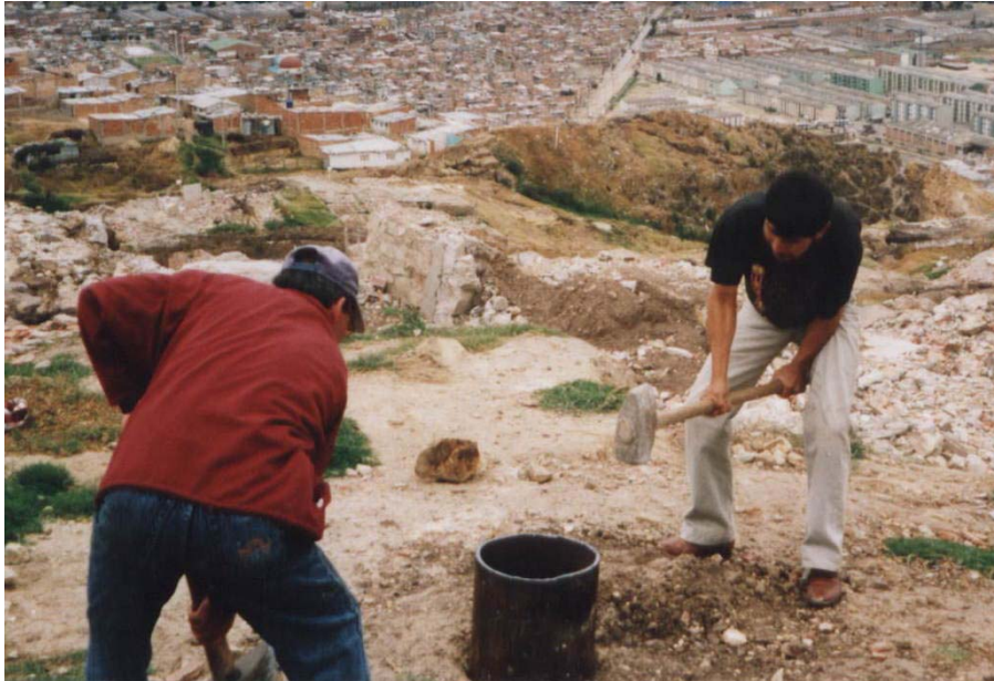
Paso 1 – Hincado del infiltrómetro en el terreno.
