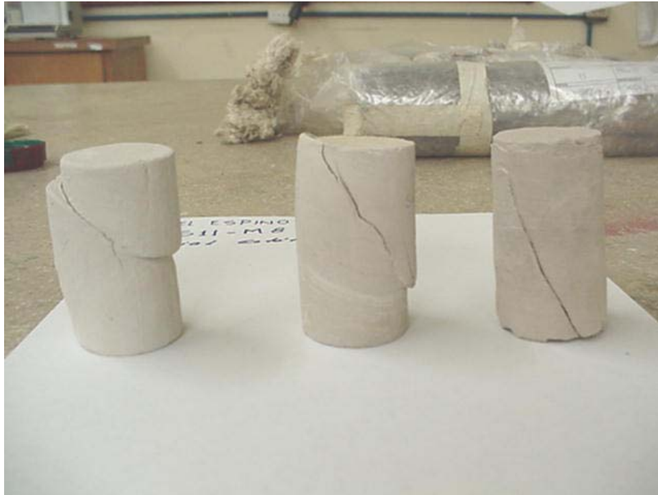
Figura 8.9. Planos de falla de la arcillolita en prueba triaxial (CU)
