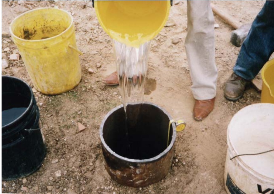
Paso 3 – Inicio del ensayo. Vertimiento de agua inicial
