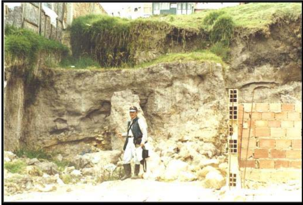
Foto 4.3. Detalle de suelo residual caracterizado por ser arenarcilloso, color gris oscuro a marrón, cuyos niveles superiores son ricos en materia orgánica. Calle 57 A, barrio Cerros del Diamante.
