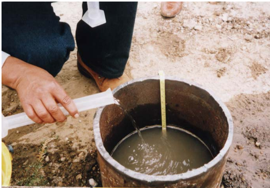
Paso 4 – En un tiempo dado se mide la cantidad de agua para mantener una cabeza constante.
