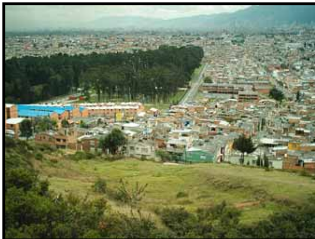
Fotografía No. 9. Ladera sur. Se observa el proceso morfodinámico cartografiado como DTE-005. La urbanización de edificios en la parte media de la imagen está cimentada sobre areniscas de la Formación Regadera. Los bosques de San Carlos ubicados al fondo, se ubican geológicamente en la Formación Bogotá.
