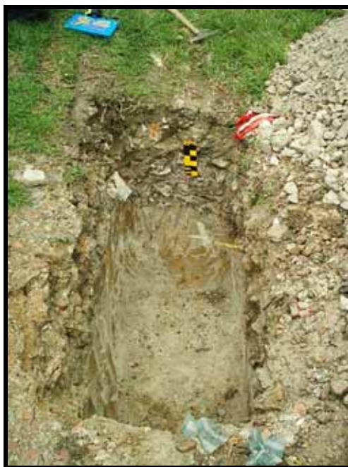
Fotografía No. 15. Apique 1, realizado en la zona del parqueadero central. Se encontraron limos rojos de textura volcánica infrayaciendo un relleno.
