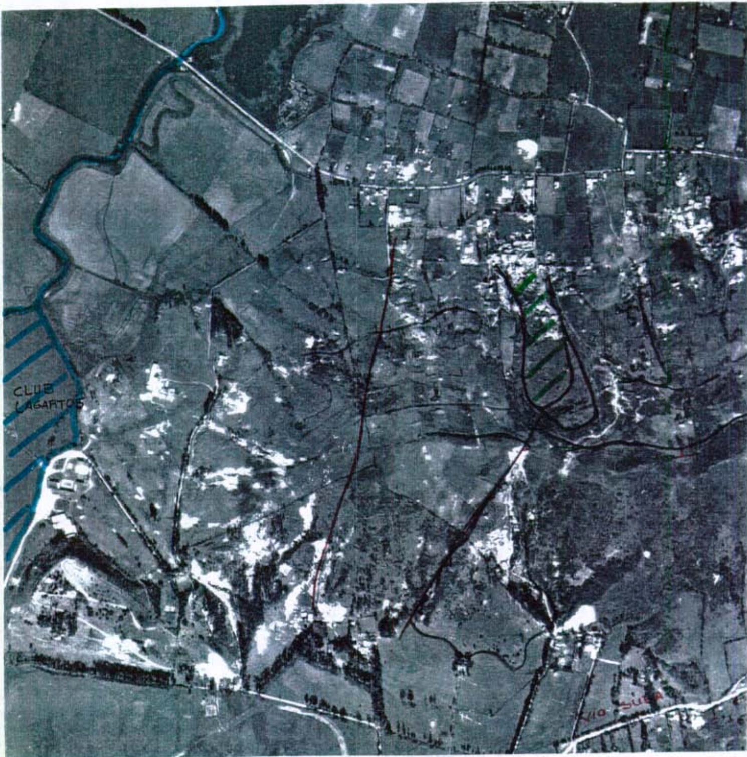
Figura No. 2 Delimitación de la zona inestable y su relación con el cruce de una discontinuidad regional (Fotografía de 1952).
