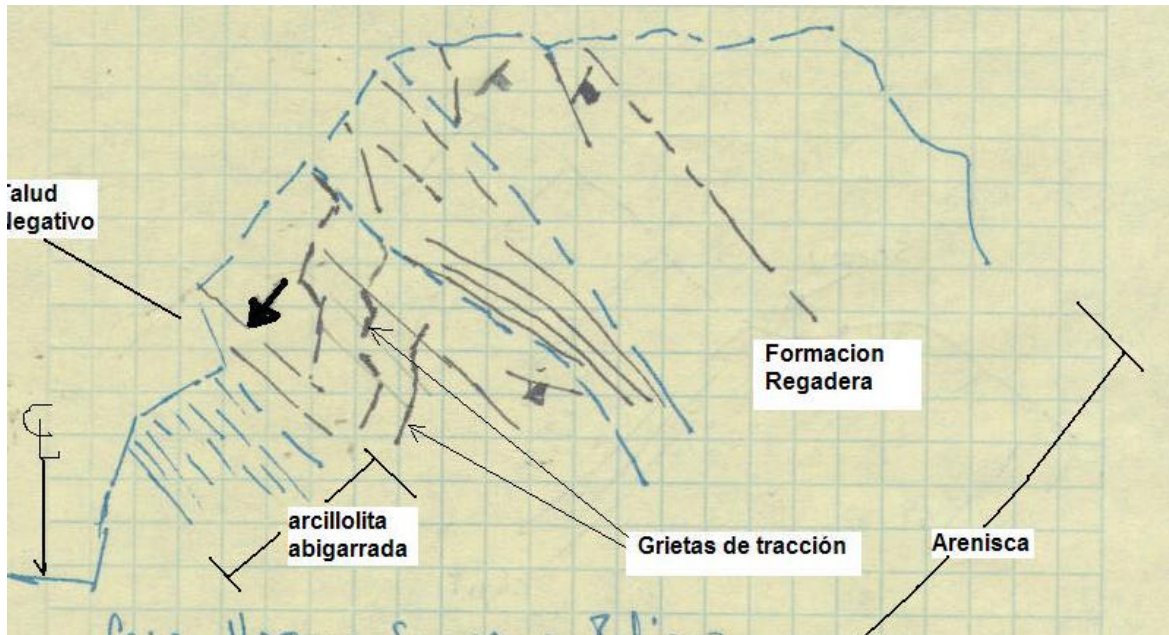
Figura 4-5 Esquema del frente de la cantera abandonada, hoy con inestabilidad.
