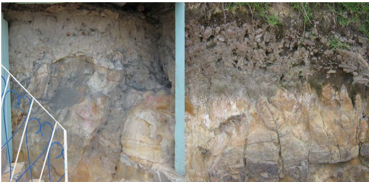
Foto 5 y Foto 6 Afloramientos de areniscas de la Formación la Regadera, Clasificadas como rocas blandas (Rb). Obsérvese en la parte superior de cada afloramiento la roca convertida en suelo residual, de color gris oscuro.
