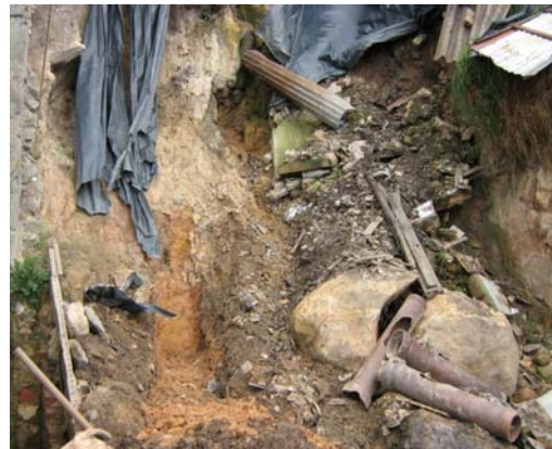
Foto 8. En la parte izquierda la apertura de un apique, que muestra las características del material rocoso.
