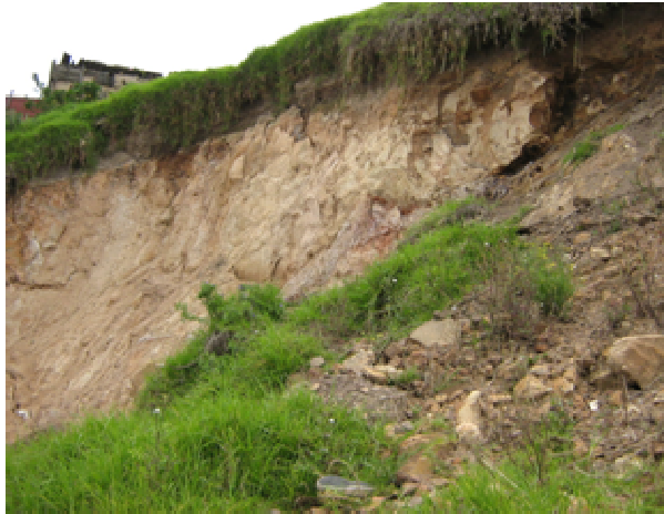
Foto 13. En la parte superior suelo residual gris oscuro, que subyace roca altamente meteorizada y caída de detritos.
