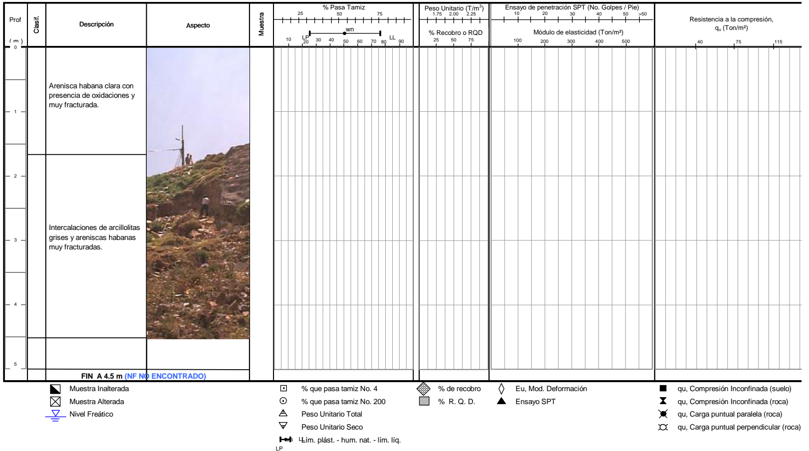
Figura 5-6 Resumen Gráfico de Propiedades Índice y Mecánicas de la Trinchera Tr-5
