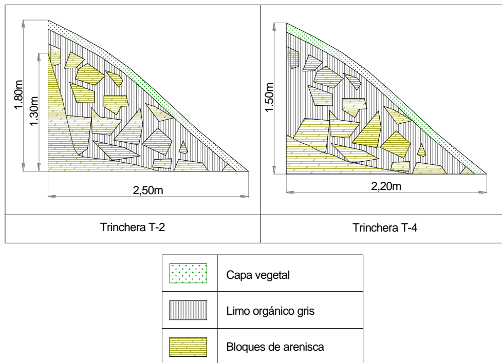
Figura 6-2 Esquema del material encontrado en las trincheras T-2 y T-4
