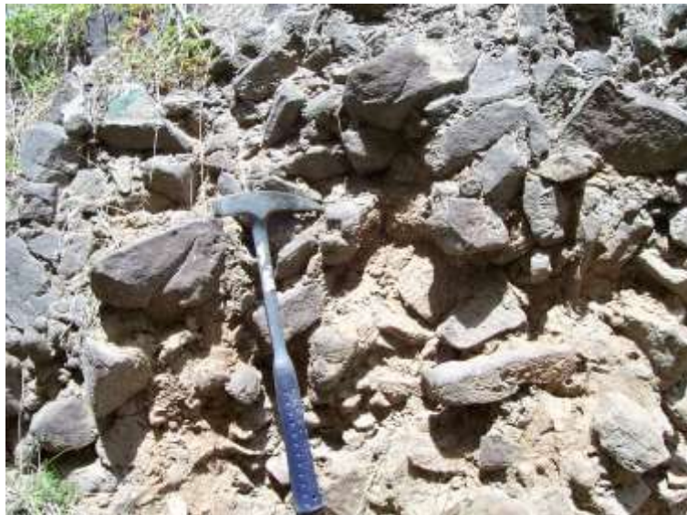
Fotografía 3-4. Deposito coluvial antiguo, clasto soportado, con fragmentos angulares a subangulares.
