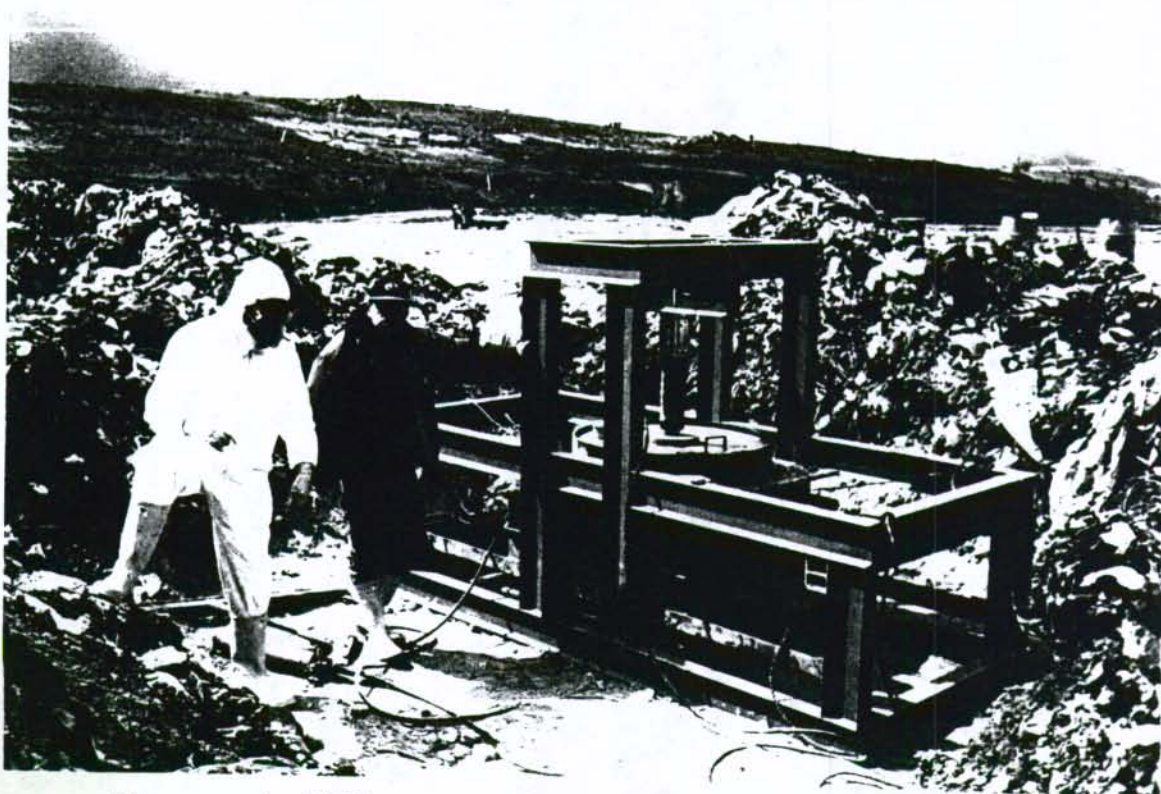
FOTOGRAFÍA 20. ENSAYOS DE RESISTENCIA AL CORTE- GRAN ESCALA
