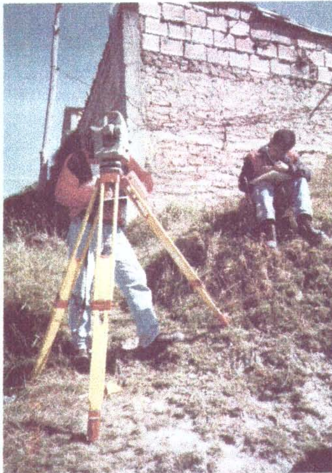
Estación Total LEICA modelo T-600, empleada para el levantamiento topográfico del área de estudio.
