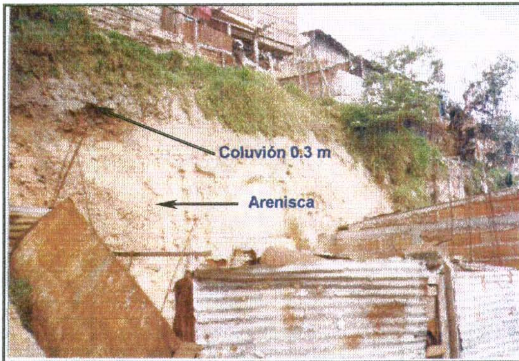
Foto 2-2.3. Coluvión colgado de poco espesor sobre un nivel de arenisca. parte posterior del predio 494 a la altura de la carrera 2C entre diagonales 41y 41 A
