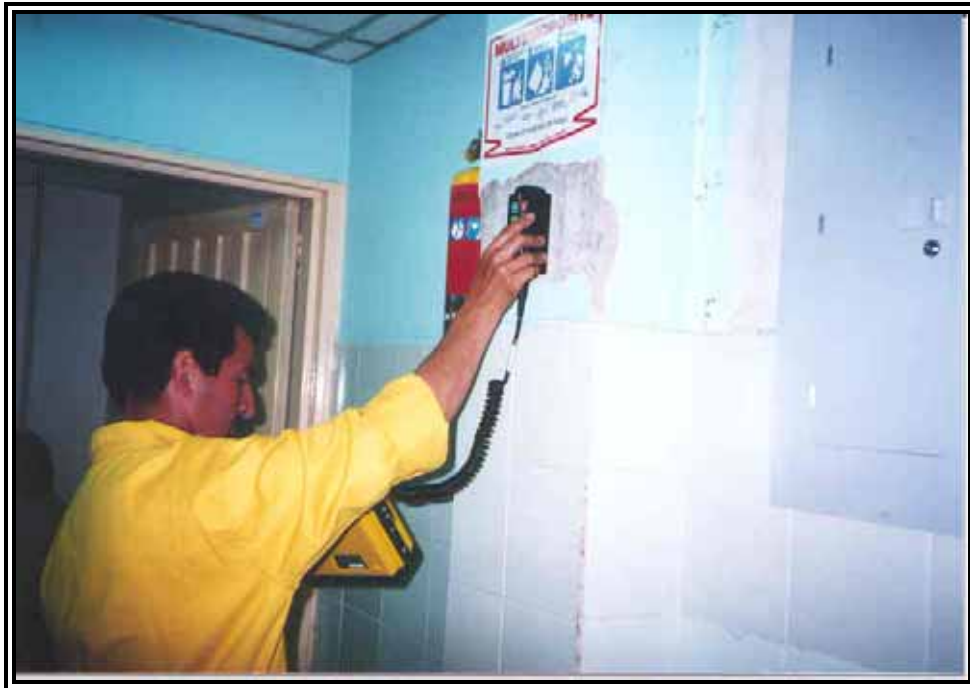
Identificación de hierros en columnas.
