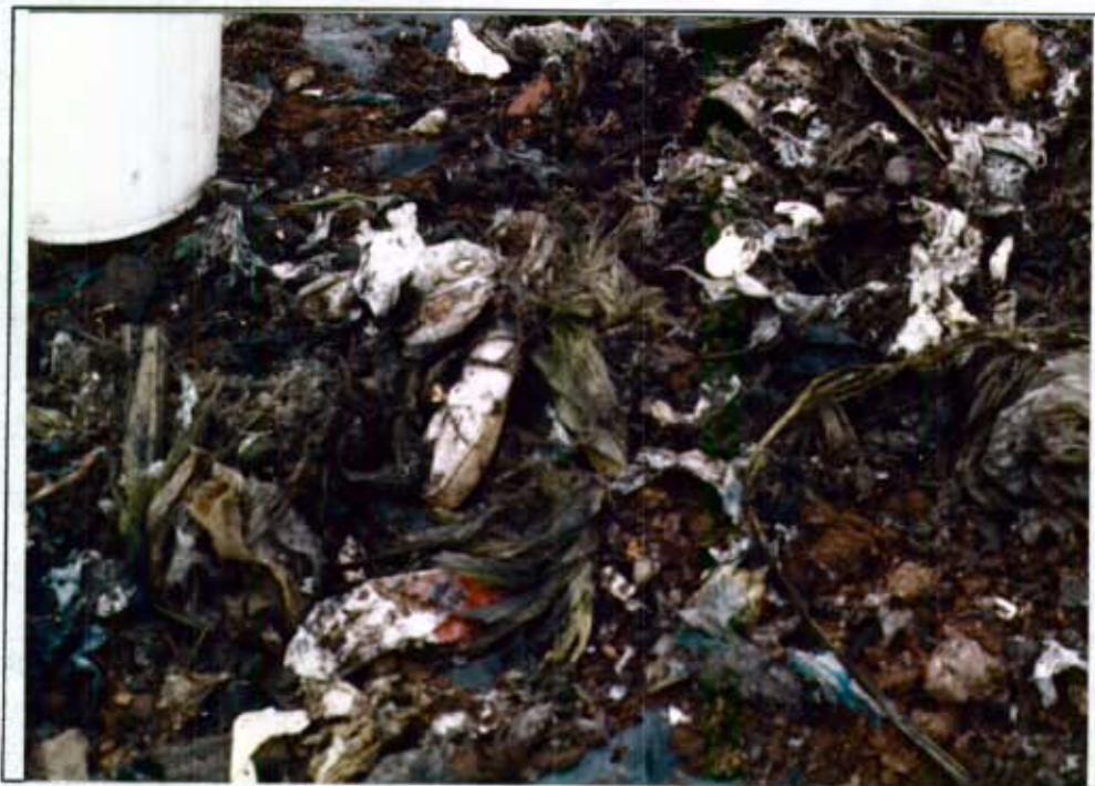
Fotografía # 27: Recuperación de basura durante la perforación de huecos de 80 cm. Nótese el contenido de materia orgánica en estado fresco, aún después de haber permanecido por espacio de 2 años dispuesta. (DJ#6 -24-24A)
