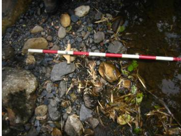
Fotografía 6 - 24. Tamaño típico del material de arrastre del río San Cristóbal aguas arriba del tanque.
