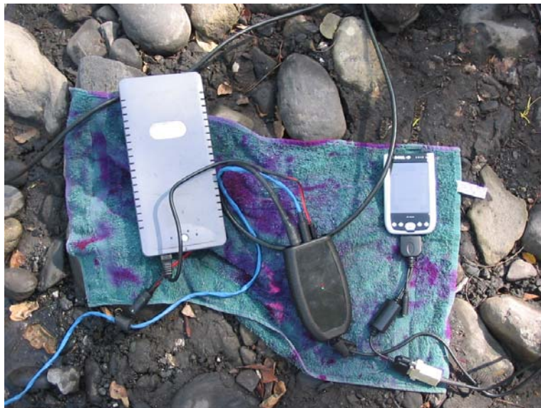
Figura 5-3. Equipo de medición de caudales
