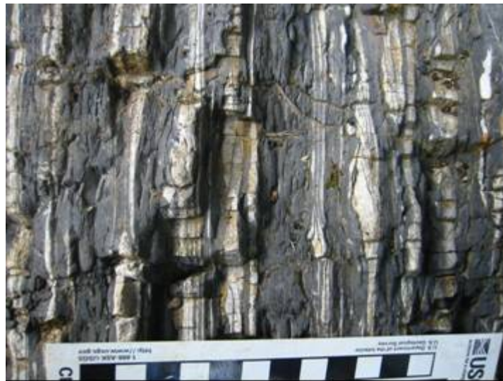
Fotografía 6 - 11. Detalle de lodolitas carbonosas intercaladas con láminas de arenisca (estructura flaser) de la Fm. Guaduas. Sector del Tanque del acueducto.
