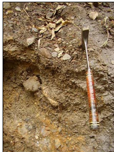
Fotografía 6 - 49. Detalle del material inestable de uno de los procesos morfodinámicos inventariados.
