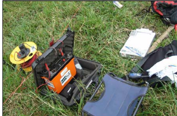
Figura 4-39. Equipo de geoelectricidad para la toma de Sondeos Eléctricos Verticales y Tomografías Eléctricas
