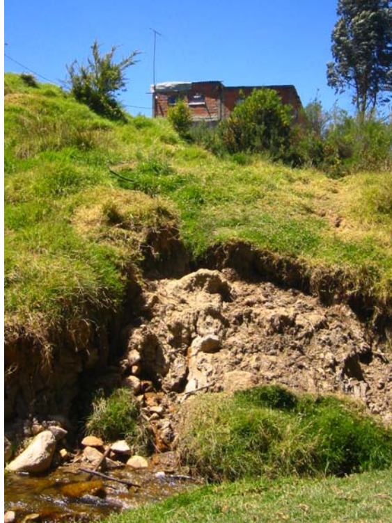
Fotografía 6 - 40. Parte terminal de un flujo de tierras, socavada por el río San Cristóbal.
