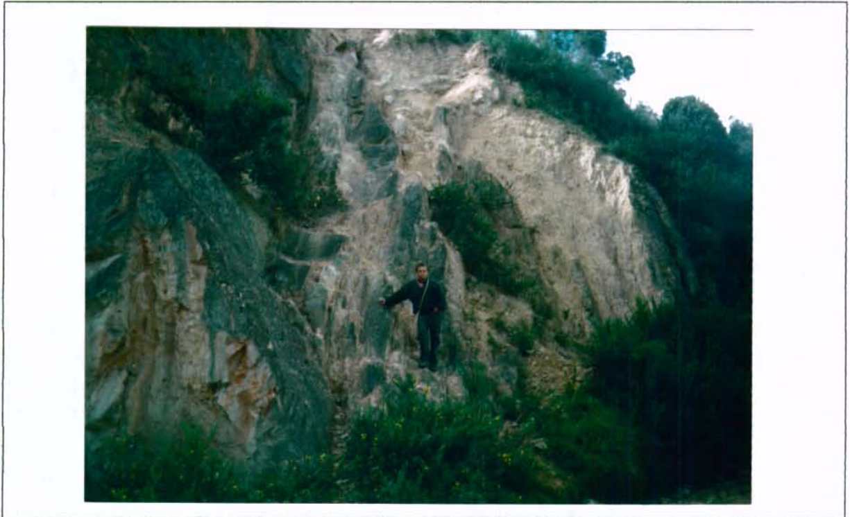
FOTO No. 6. Arenisca disturbada y buzamiento paravertical (E \sim 85^\circ al oriente). Se observa gruesa capa de suelo residual y clastos. Foto EPR – Sept/99. Cuadro No. 7, rollo 8692
