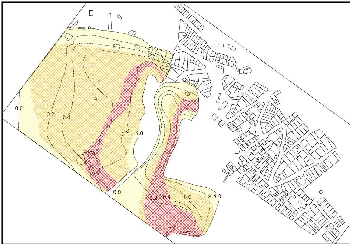
Figura 11-2. Zonas de amenaza por caída de rocas resultado de la ejecución de obras correspondientes a la alternativa 2.
