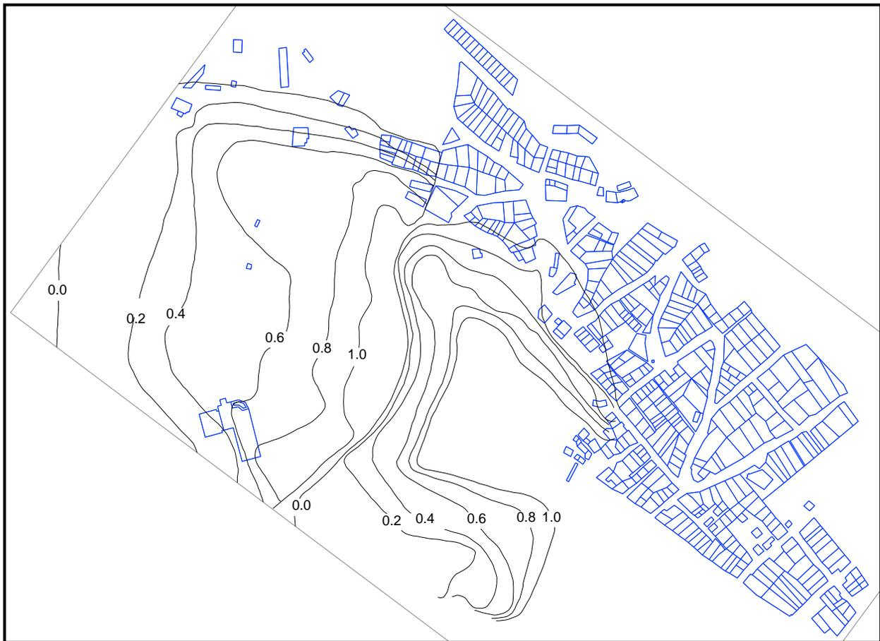
Figura 8-2. Curvas de isoprobabilidad de alcance de bloques
