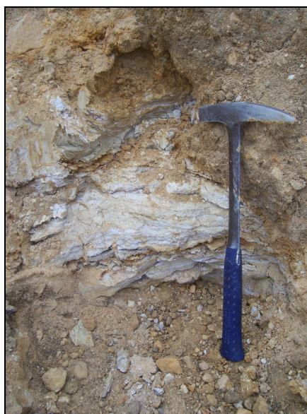
Foto 3.4 . UNIDAD DE LODOLITA 2 (KSGT L2), EN LA CORONA DEL DESLIZAMIENTO. LA UNIDAD PRESENTA CAMBIOS LATERALES HACIÉNDOSE MÁS ARENÁCEA HACIA EL SUR, LO CUAL DIFICULTA LA CARTOGRAFÍA DETALLADA A NIVEL DE UNIDADES GEOLÓGICAS DE ROCA.
