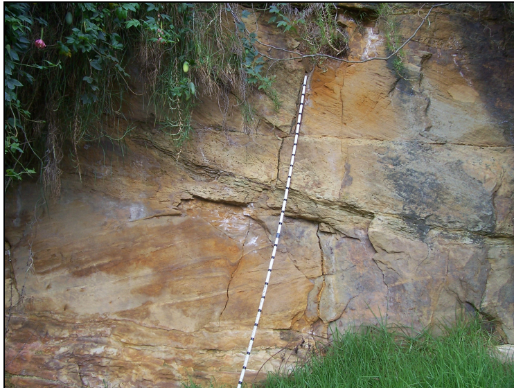
FOTO 3.5 ARREGLO DE ESTRATIFICACIÓN INTERNA INCLINADA, EN ARENISCAS DE GRANO GRUESO DE LA UNIDAD ARENISCA 3 (KSGT A3). ESTA UNIDAD CONFORMÓ LA MASA DESLIZADA EN LA PARTE SUPERIOR DEL DESLIZAMIENTO DE MAYO DE 2006.
