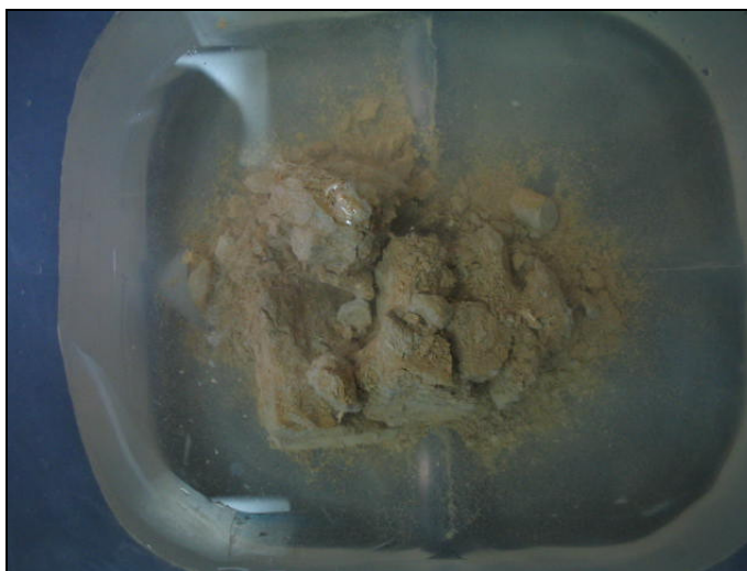
FOTO 4.2 ARENISCA LODOSA SOMETIDA A SATURACIÓN TIEMPO 5 MIN.
